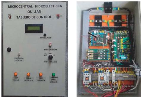
Fig. 20 Parte externa e interna del tablero de control implementado.
