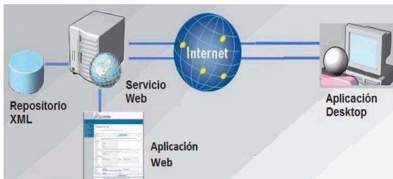
Fig 1. Elementos del prototipo de sistema distribuido
