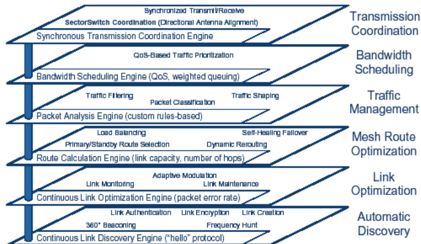
Gráfico 1.15 Capas de la arquitectura SyncMesh SkyPilot [31]
