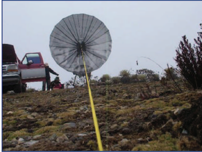
Gráfico A8.6 El cordel atado a la antena nos ayuda a determinar la alineación y a alejar la brújula de objetos ferromagnéticos que puedan alterar su lectura
