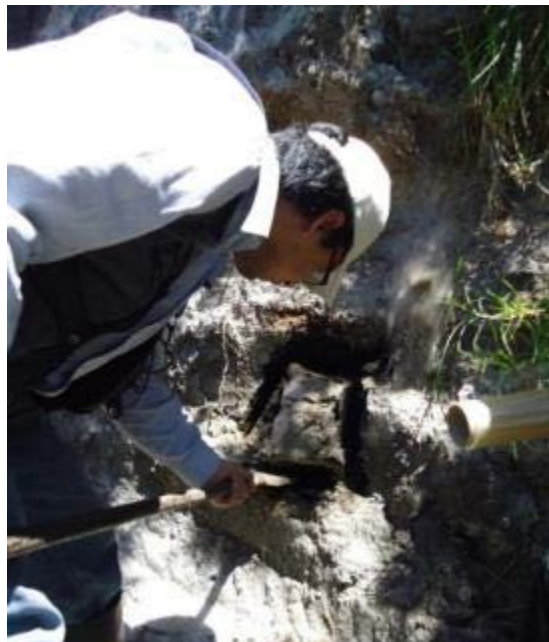
Fotografía 3.2. Extracción de muestra de suelo para el ensayo de corte directo.
