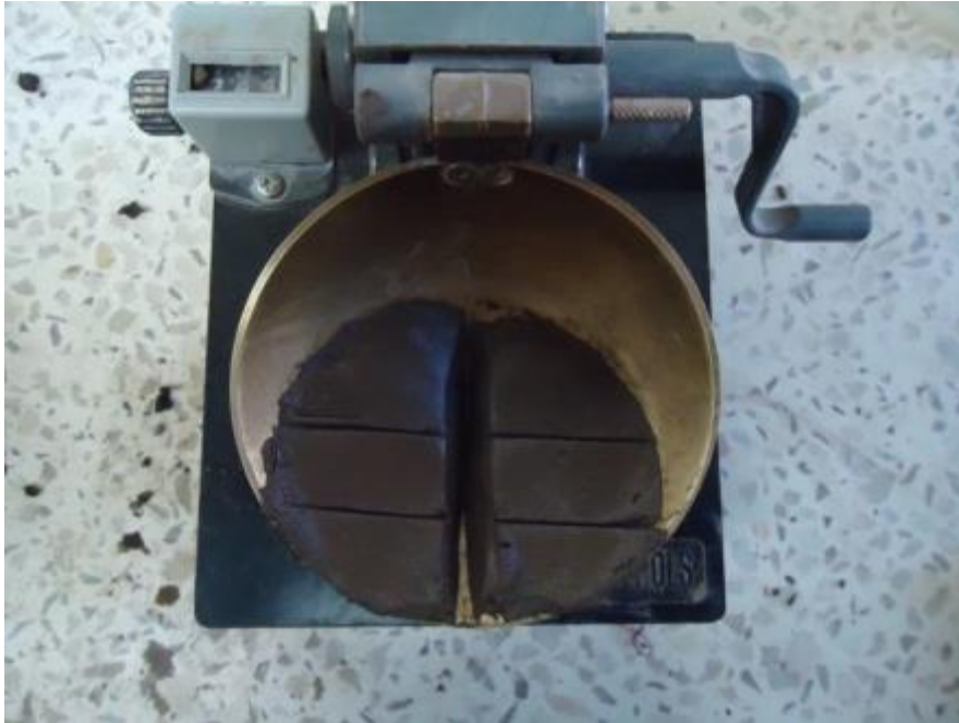
Fotografía 3.7. Estimación del límite líquido (LL), empleando una Cuchara de Casagrande.
