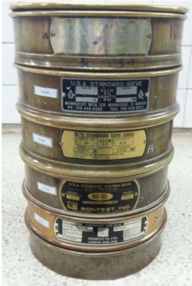
Fotografía 3.4. Serie de tamices: No.4, No. 10, No.20, No. 40, No. 200 y Bandeja de recolección.
