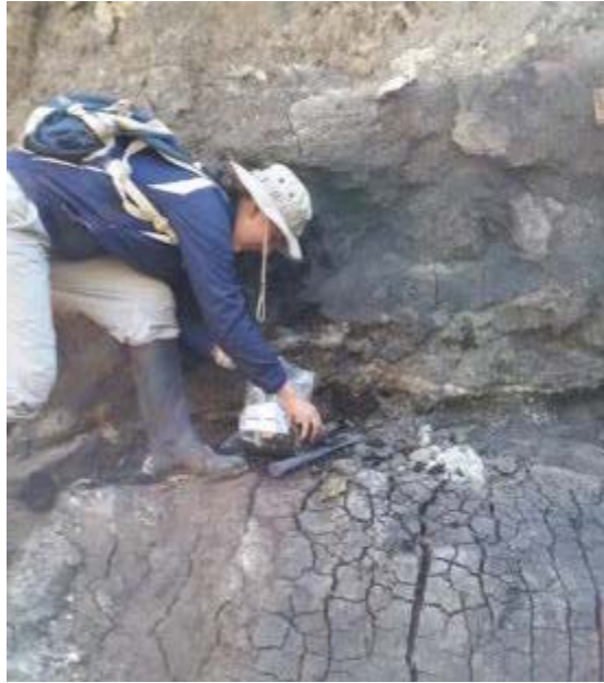
Fotografía 3.1. Toma de muestras para el ensayo S.U.C.S.
