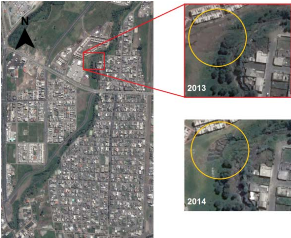
Figura 5.6. Deslizamiento en el perfil "G" y "H" en los años 2013 y 2014. Fuente: Google Earth, años 2013-2014.
