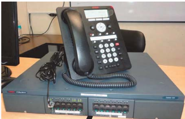
Fig. 1 Vista Frontal de la Unidad de Control IP 500 V2 Junto a un Teléfono IP
