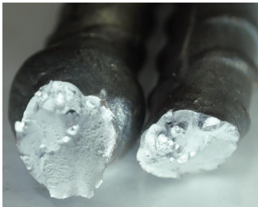
FIGURA 5.53: Fractura por imperfecciones en la soldadura
