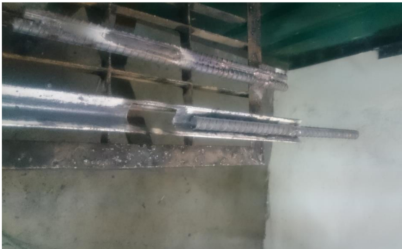
FIGURA 4.9: Probetas en soporte para soldadura
