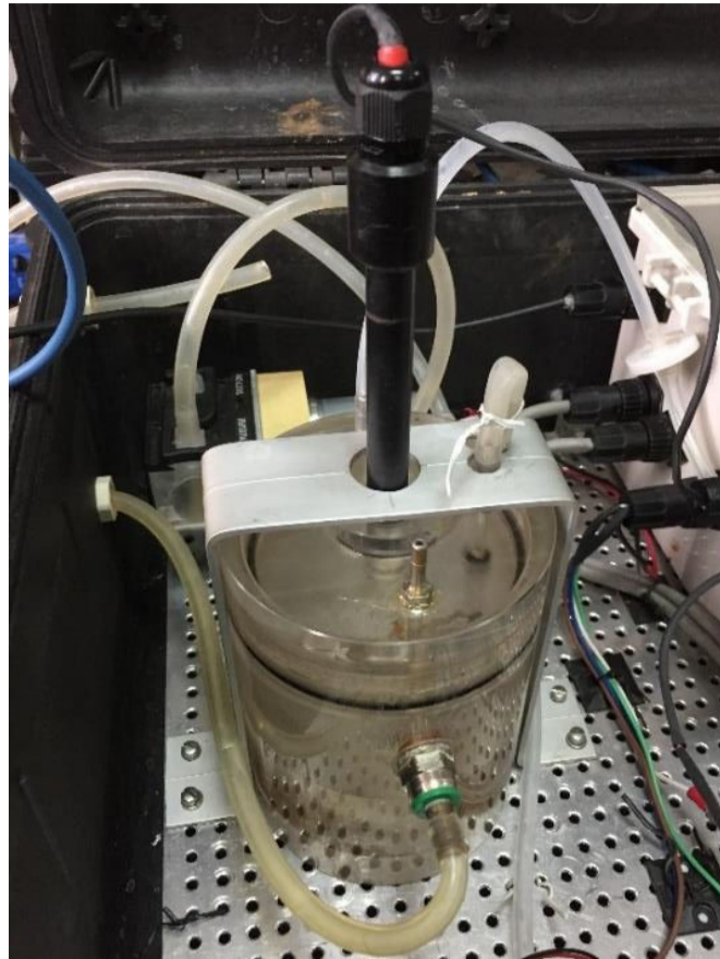
Figura 4.24. Sensor RTD montado sobre un encapsulado para el acople con la cámara de equilibrio.
