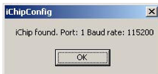
Figura 3.16. Mensaje de conexión exitosa entre el computador y el convertidor serial a Ethernet.
