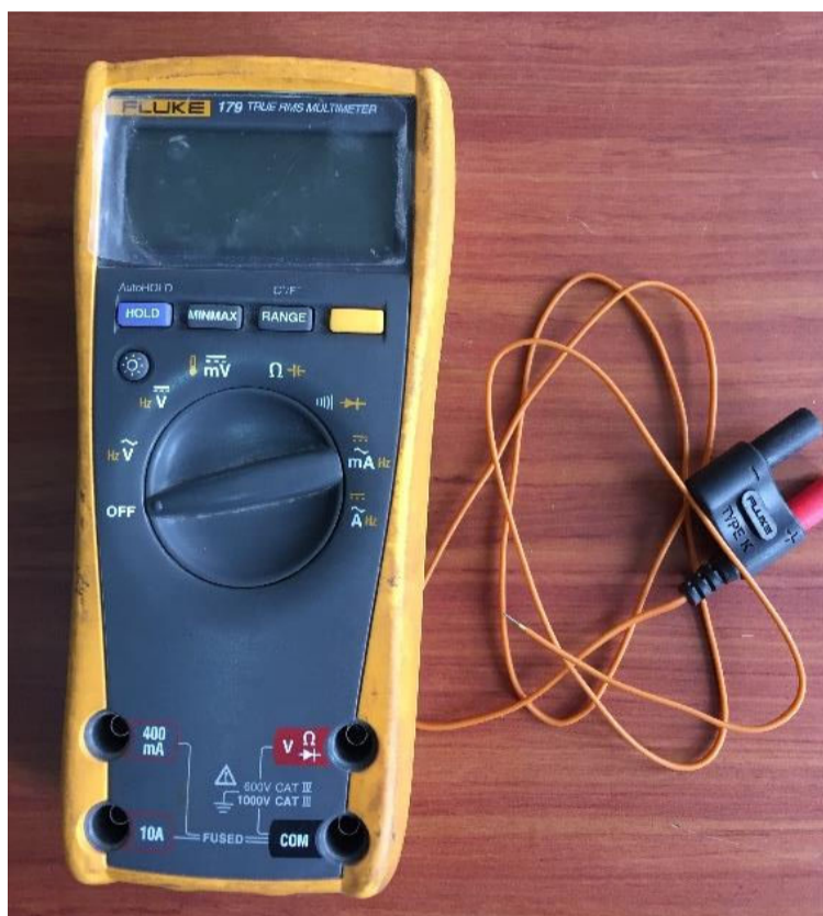
Figura 4.23. Multímetro FLUKE 179 TRUE RMS y termocupla tipo K utilizados para la comprobación de los sensores de temperatura.
