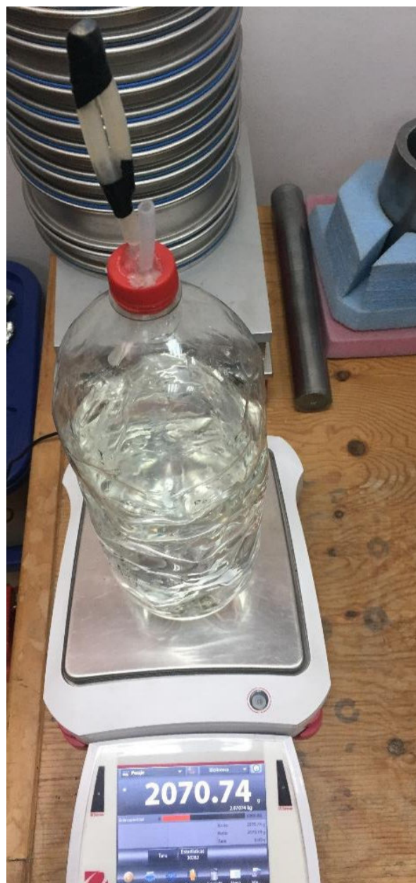
Figura 4.18. Medición del peso total de la botella con dos litros de agua y la tapa con las mangueras.
