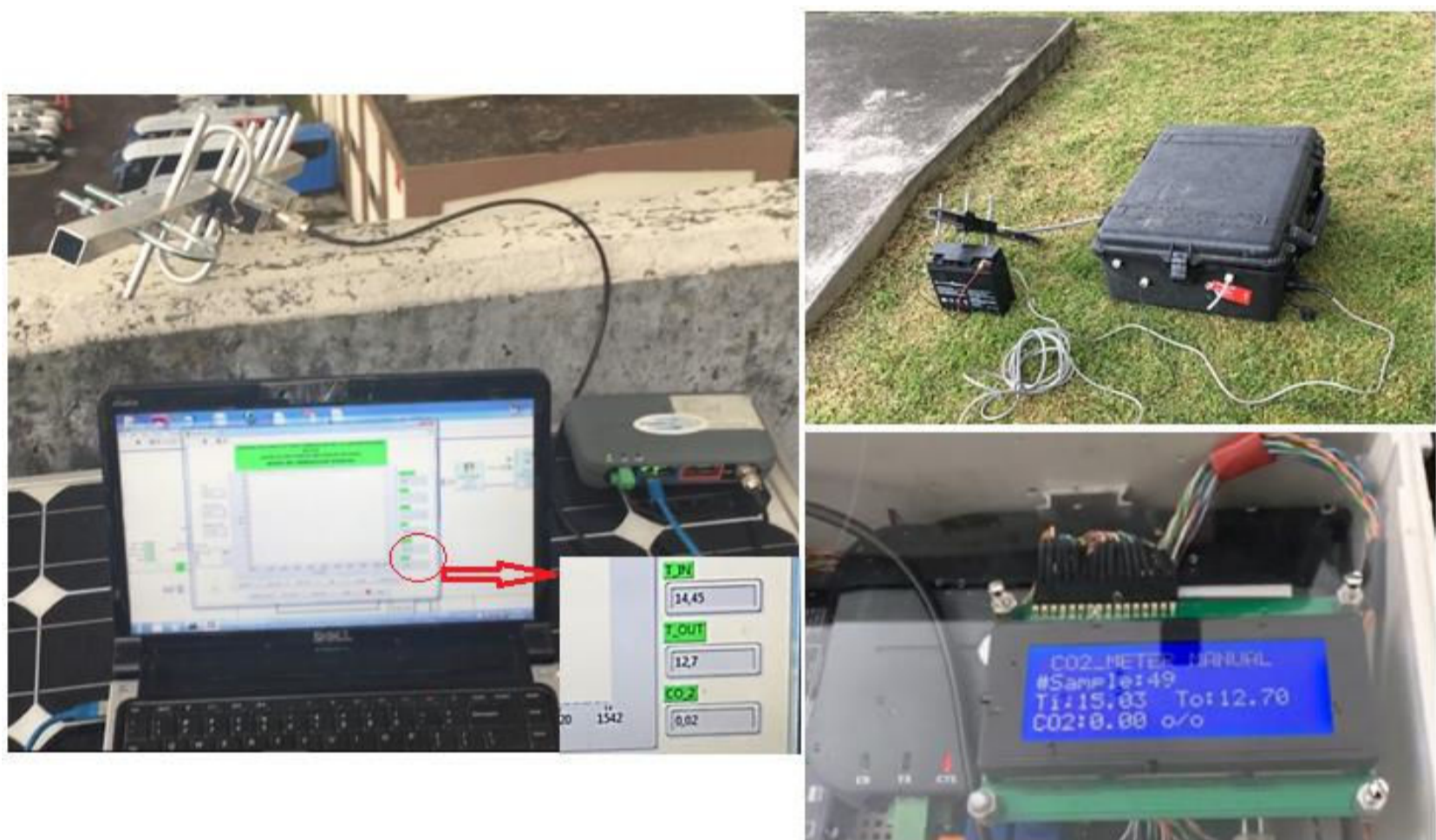
Figura 4.31. Segunda prueba de transmisión de datos mediante radio enlace.
