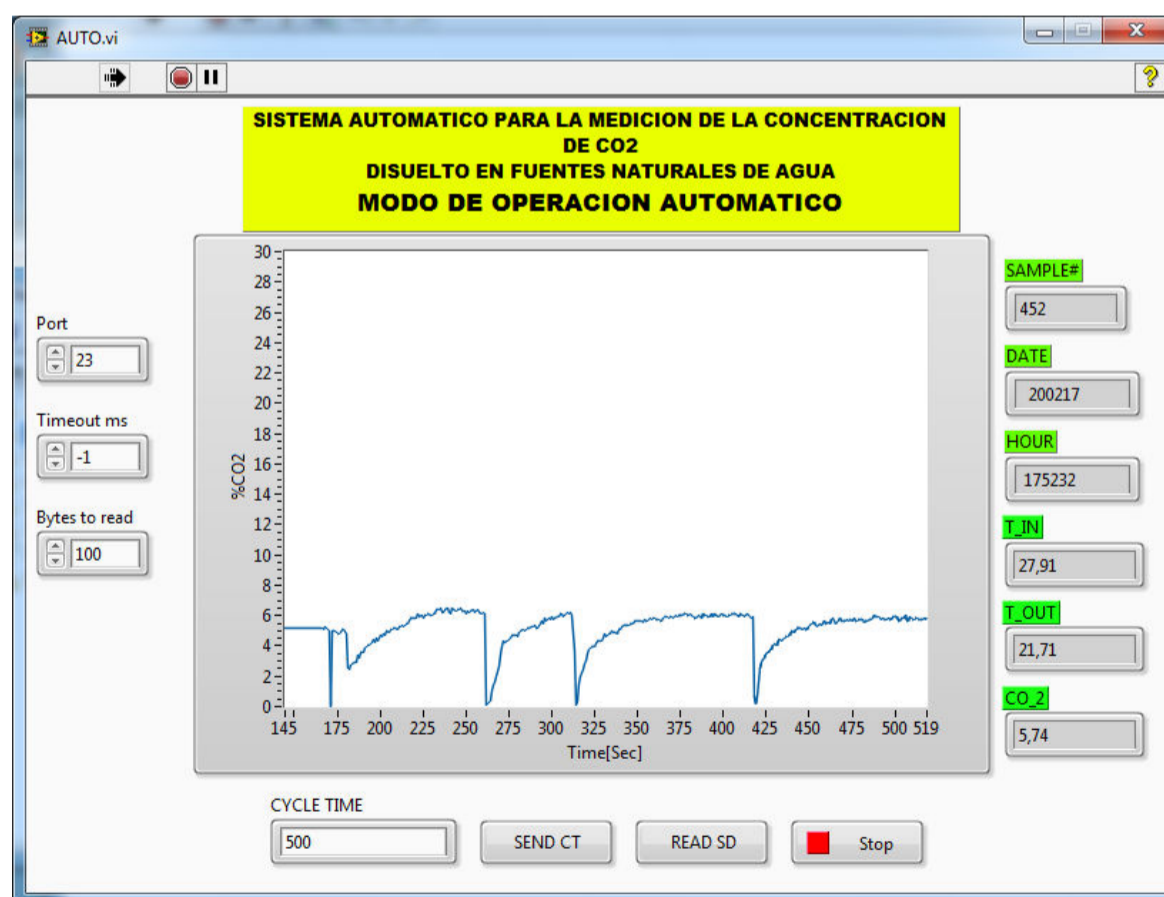
Figura 3.23. Ventana para la operación automática del sistema.
