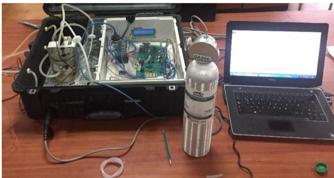
Figura 4.8. Equipo conectado a la botella que contiene la mezcla de precisión de H 2 S-Nitrógeno y al computador para registrar los datos de la calibración.
