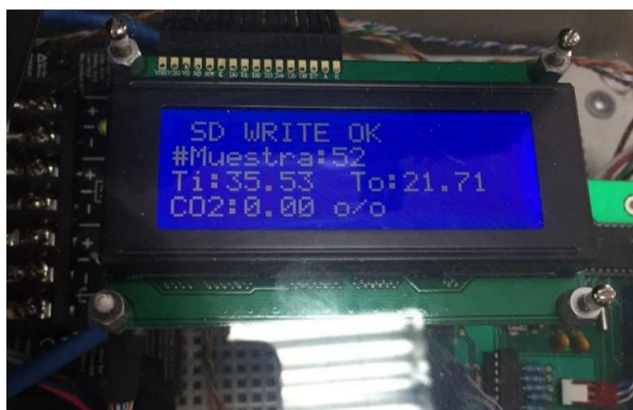
Figura 4.20. Temperatura ambiente (To) registrada por el instrumento al momento de realizar la disolución.
