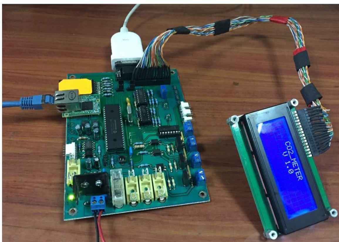
Figura 2.40. Primera prueba de operación del circuito ensamblado.
