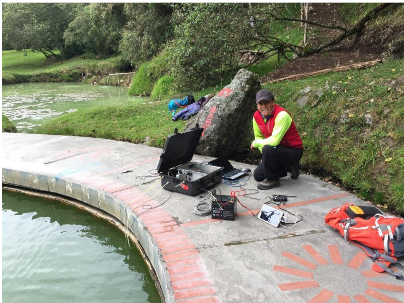
Figura 4.34. Instalación de los equipos para realizar las pruebas de medición de la concentración de \text{CO}_2 disuelto en agua, en la fuente Palmira.
