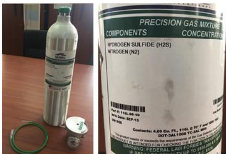
Figura 4.5. Botella que contiene la mezcla de gases de precisión de H 2 S y Nitrógeno.
