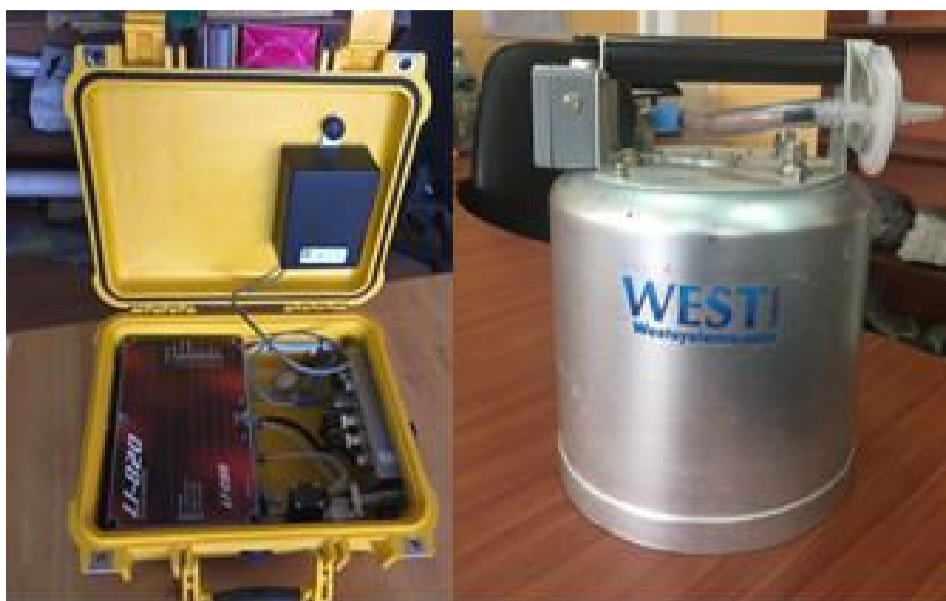
Figura 1.3. Instrumento para la medición de la C_{CO_2} , que utiliza la técnica de cámara invertida propiedad del IG-EPN.
