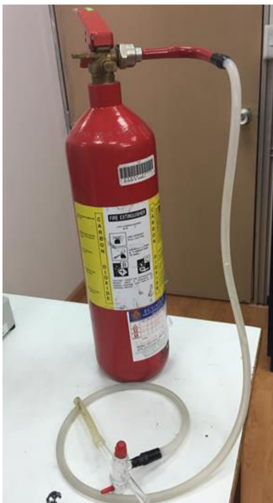
Figura 4.13. Cilindro de CO 2 y válvula de tres vías.
