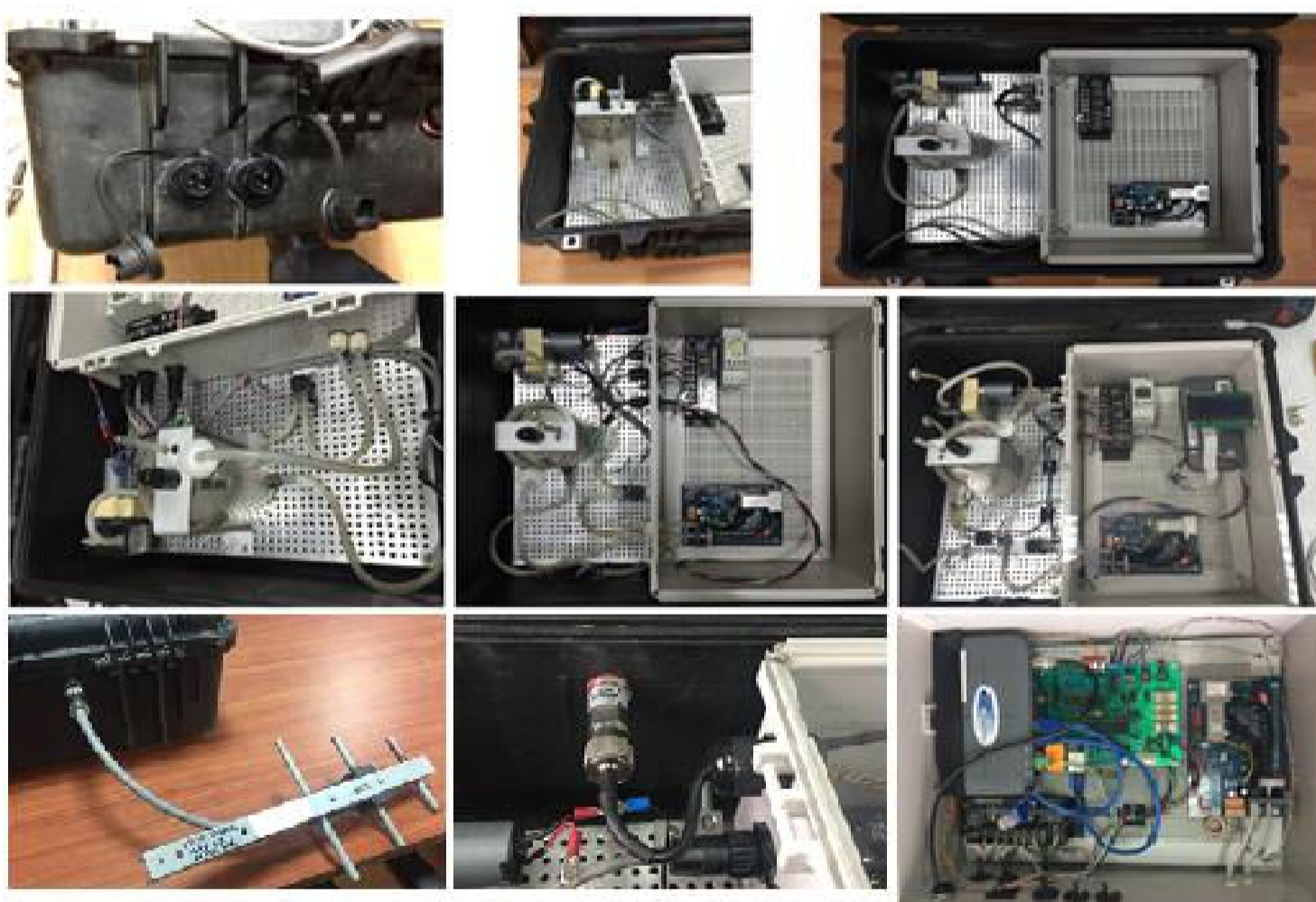
Figura 2.42. Proceso de montaje de los elementos del sistema automático.
