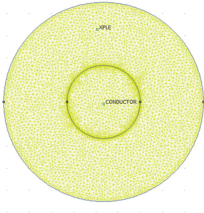
Figura 1.9 Discretización del cable ejemplo 1.1.
