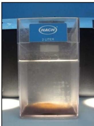
**Figura 3.9.** Agua residual obtenida con la adición de 5 ml de sulfato de aluminio
