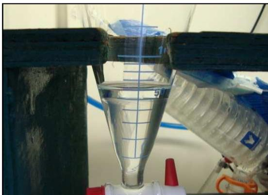
**Figura 2.5.** Separación de cloroformo y agua en el embudo de separación
