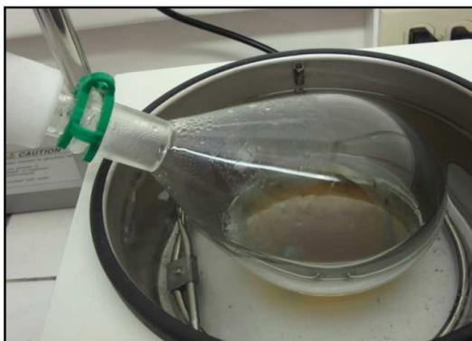
**Figura 2.4.** Balón con cloroformo colocado en el agua de calentamiento
