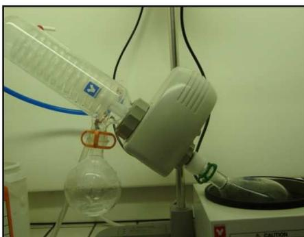
**Figura 2.3.** Evaporador rotativo Yamato BM 100
