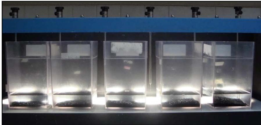
**Figura 2.6.** Carbón activado granular colocado en cada jarra en diferentes cantidades
