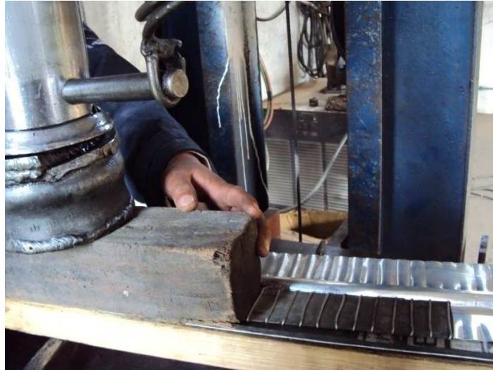
Fig.2.33.- Realización del relieve en toda la lámina
