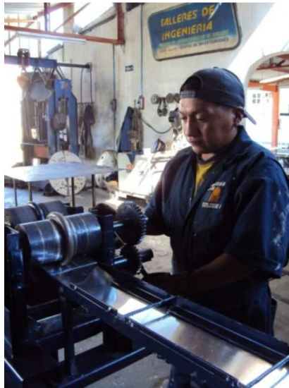
Fig.6.2.- La imagen muestra el preformado del canal en la lámina de aluminio, este preformado se lo realiza mediante la rotación del cilindro que se aprecia en la parte frontal de la máquina, el movimiento de rotación del cilindro es transmitido por los engranes cuyo giro se lo debe al operador, el cual gira de la palanca como se muestra en la foto, el giro de la palanca realizado por el operador es en el sentido contrario al de las manecillas del reloj.
