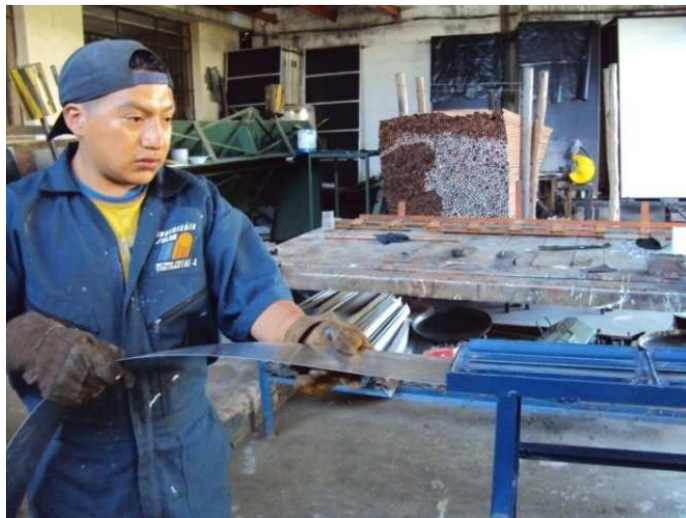
Fig.6.1.-En esta foto el operario inserta la lámina en la máquina preformadora por su parte frontal.
