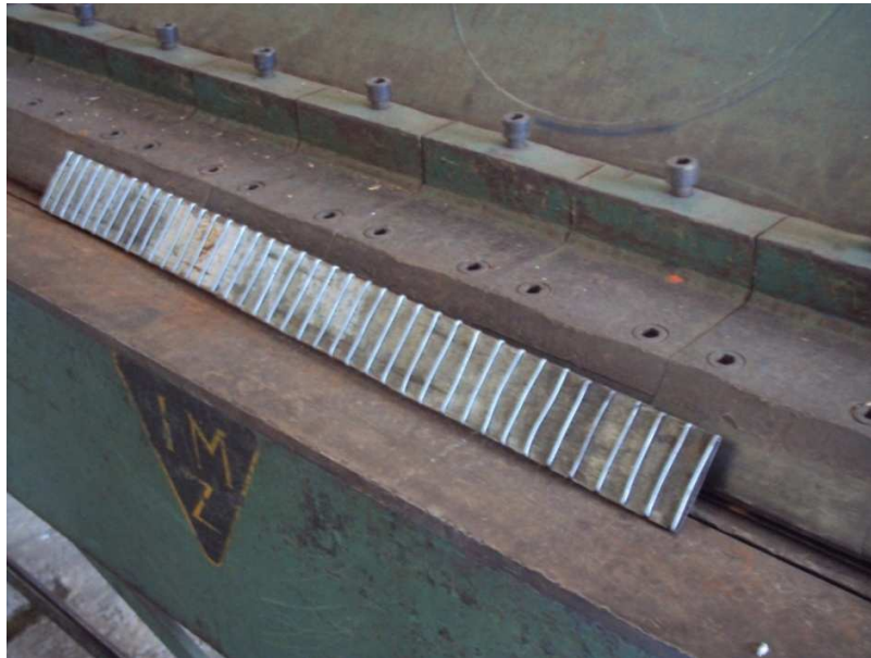
Fig.2.24.- herramienta que permite realizar el relieve o aleta del perfil
