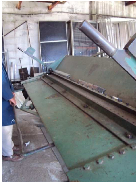
Fig.2.11.- dobles de la lámina de aluminio a través del levantamiento de la oreja
