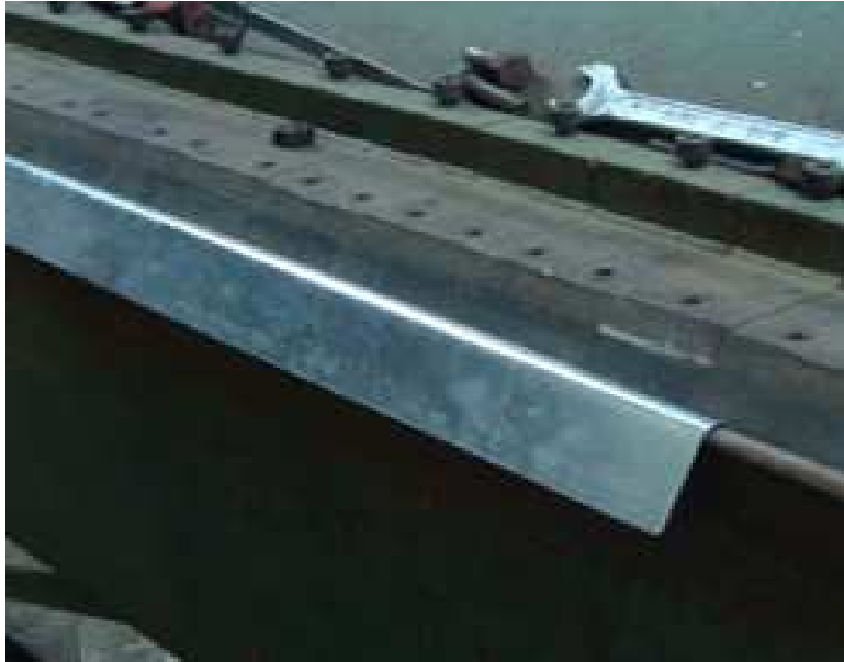
Fig.2.21.-Formación del canal del perfil
