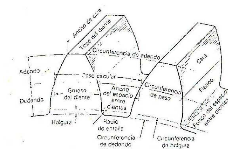
Fig.2.6.1.-Nomenclatura de los dientes de engranajes
