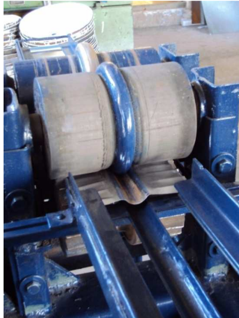
Fig.6.4.- Realización del relieve en la lámina de aluminio, este relieve se forma en la parte posterior de la máquina preformado.
