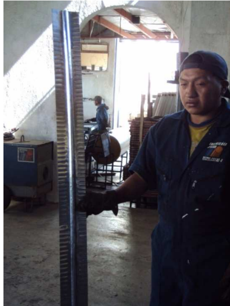
Fig.6.6.-Culminación del preformado de la lámina de aluminio que constituirá el perfil solar económico
