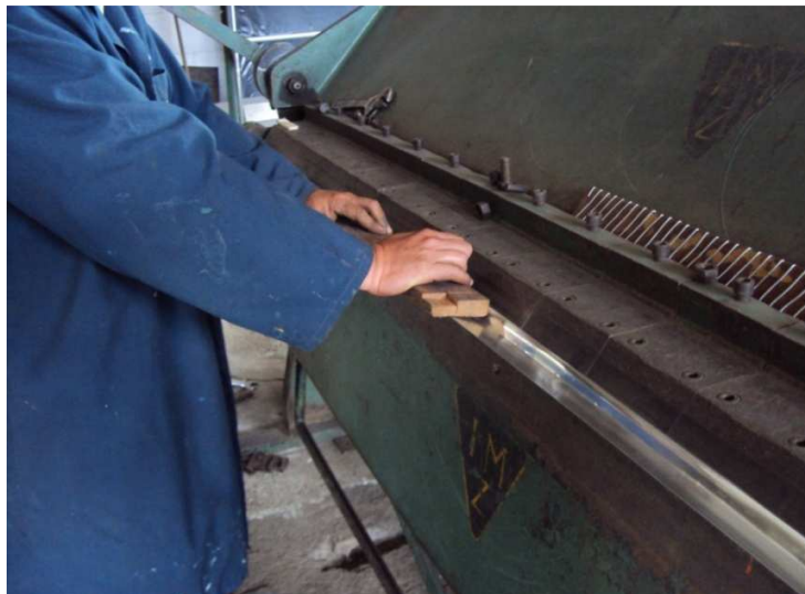
Fig.2.20.-Formación del canal manualmente
