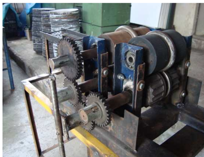
Fig.6.1.1.- Sistema de preformado sobre estructura metálica
