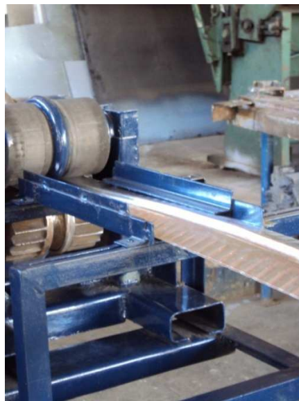
Fig.6.5.-Preformado que se realiza sobre la lámina de aluminio
