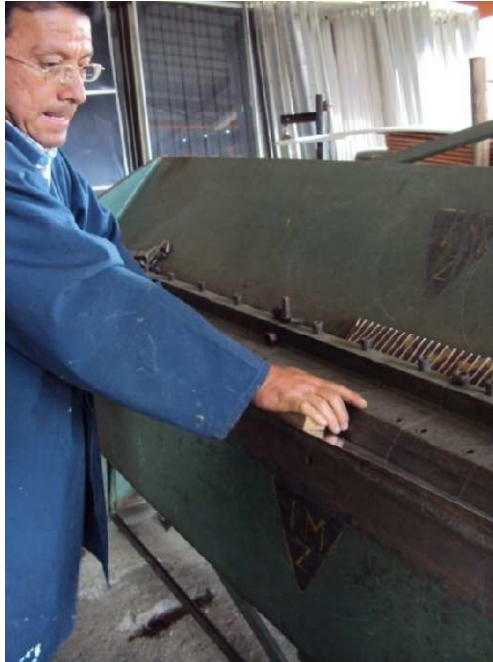
Fig.2.19.- formación del canal manualmente
