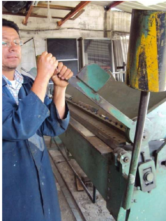
Fig.2.10.- Ajuste de la máquina dobladora mediante la palanca
