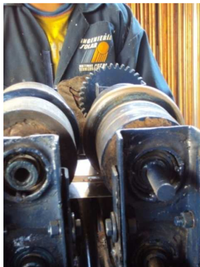
Fig.6.3.-Se observa la realización del canal en la lámina de aluminio la cuál ingresa al otro sistema de rodillos para la realización del relieve.
