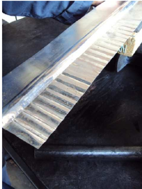
Fig.2.32.- relieve realizado mediante prensa
