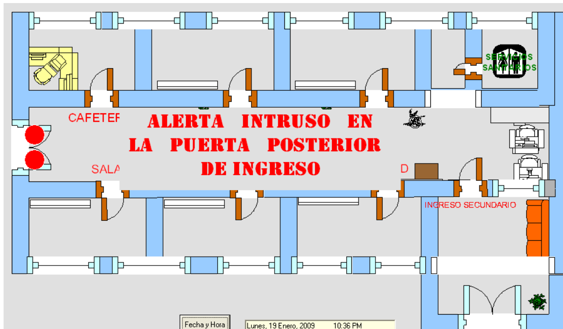
Figura 3.14 Sistema de Monitoreo Alarmado
