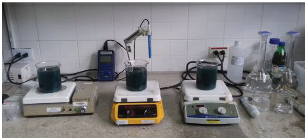
Figura 3.8. Instalación para los ensayos de coagulación-floculación
