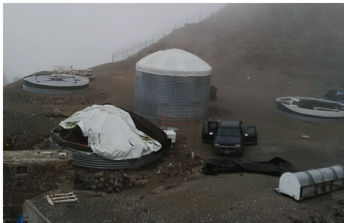
Figura 2.8: Vista del sitio LAGO-México, en Sierra Negra, Puebla. Arreglo de WCD de 7.3 m de diámetro: 3 tanques laterales de 1m de alto, y 1 tanque central de 7.3 m de alto.
