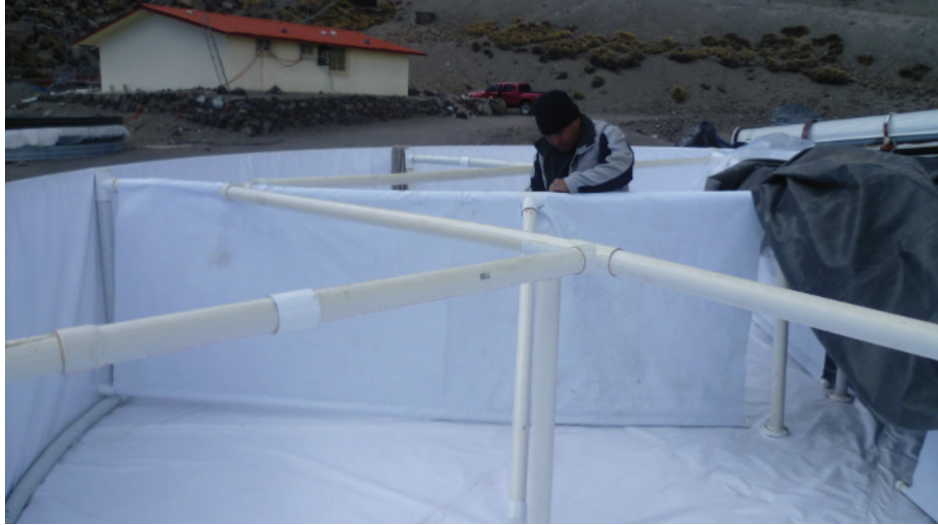
Figura 2.9: Vista interna de los detectores WCD con Tyvek. Para referenciar las dimensiones en el interior se ve a una persona haciendo arreglos.
