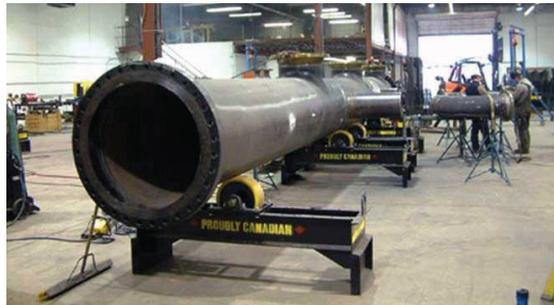
Figura I.15. Rotadores (posicionadores) de tubería en un taller de pre-fabricación.
