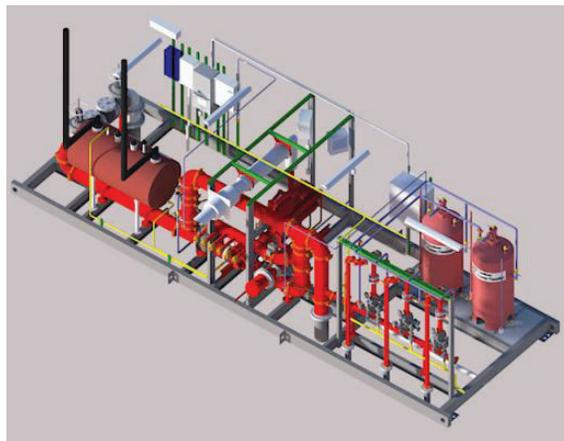
Figura I.19. Paquete bomba y motor diesel con tanque de espuma contra incendio.
