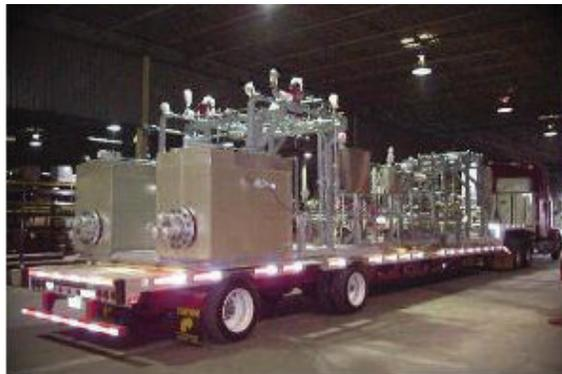
Figura I.20. Envío de una reducción catalítica selectiva (SCR), formada por módulos de vaporizador, descarga y compresión.
