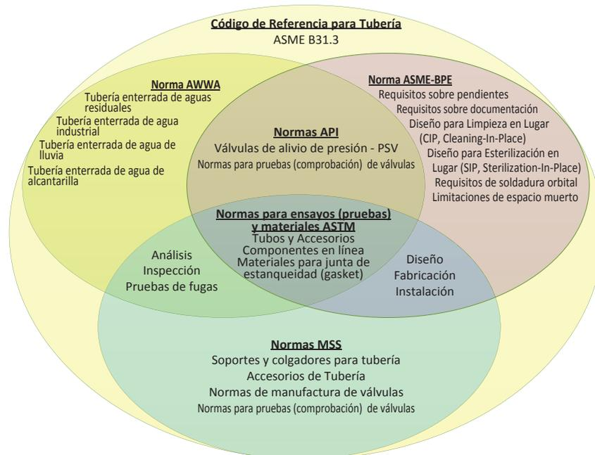
Figura 1.18. Diagrama de Venn sobre requerimientos de códigos y normas para Tubería de Procesos.
