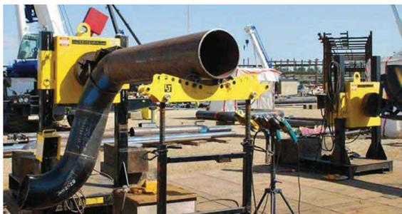
Figura I.17. Rotador (posicionador) en una fabricación en campo.
