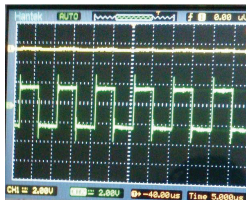
Figura 4. 4 Respuesta a una Onda Cuadrada de 100KHz del AD8055.
