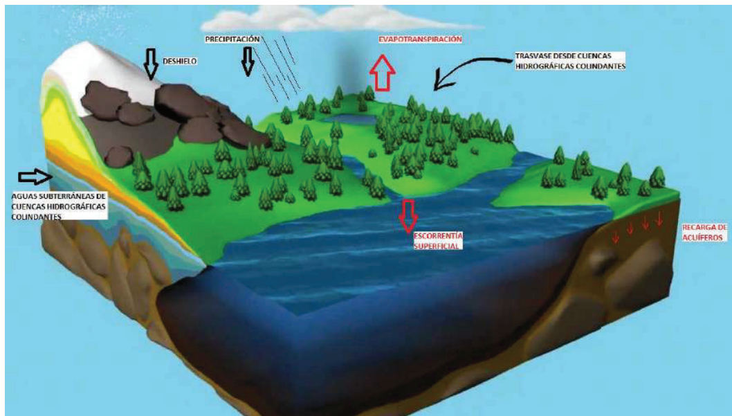
FIGURA 5.1: Entradas y salidas de agua en una cuenca hidrográfica ELABORADO POR: Ana Quishpe
