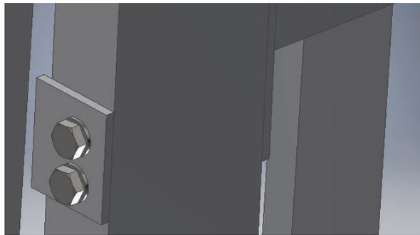
Figura 3.38. Junta emperrada tipo 4.
