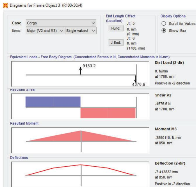
Figura 3.29. Momento flector y deflexión máxima generada en el perfil lateral.
