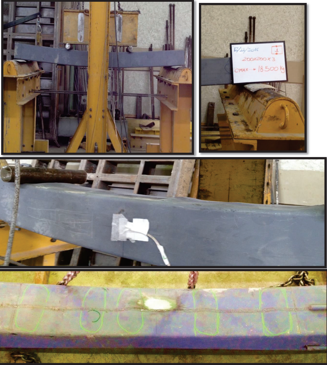
Fotografía 5.2 Ensayo y fallas resultantes del ensayo 1.
