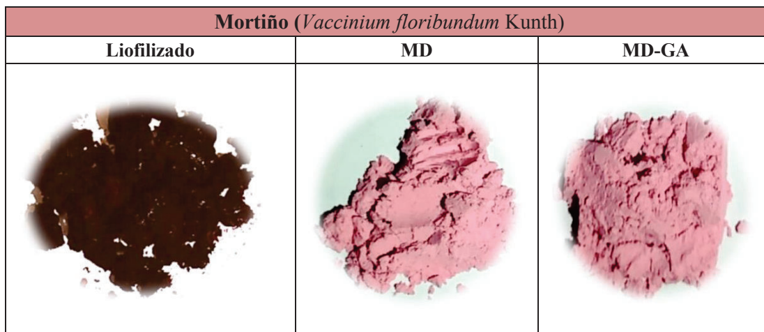
Figura 3.3 Fotografías de liofilizados y microencapsulados obtenidos de mortiño con maltodextrina (MD) y maltodextrina-goma arábica (MD-GA)
