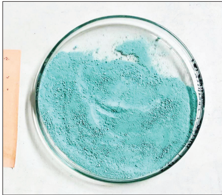
Figura 3.14. Producto del proceso de obtención de oxiclорuro de cobre a partir de cobre reciclado a escala laboratorio con NaOH como agente neutralizante
