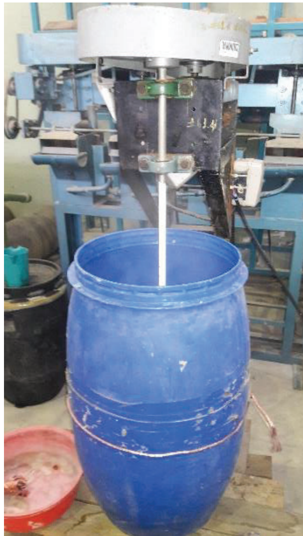
Figura 2.3. Montaje del ensayo para la producción de oxiclورو de cobre a partir de cobre reciclado a nivel piloto
