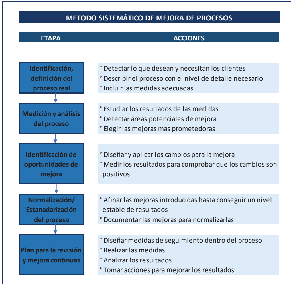
Figura 3 - Método Sistemático de Mejora de Procesos (Zaratiegui, 1999)
