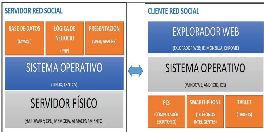
Figura 3.11. Descripción de la plataforma del prototipo, diseño modular
