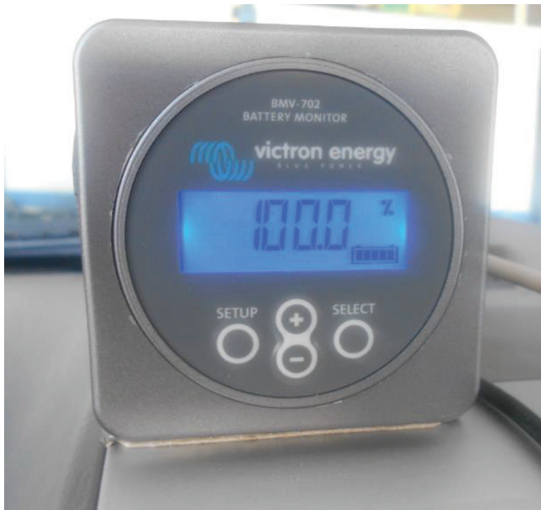
Figura 2.3. Monitor BMV – 702. (Fuente: Propia, 2016)
