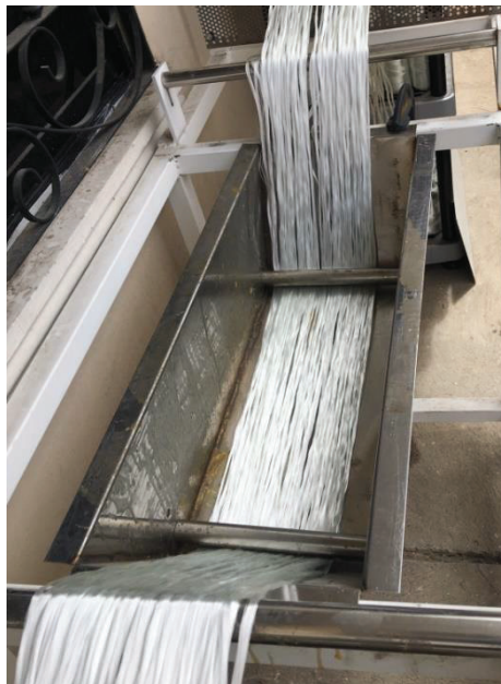
Figura 67. Tanque de resina – paso de hilo rovings. (Fuente: Adaptado de fuente propia).
