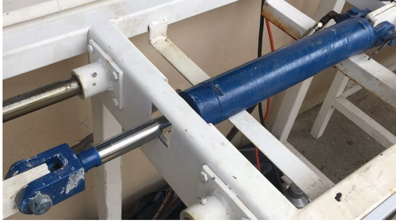
Figura 46. Cilindro Hidráulico de doble efecto primer puller. (Fuente: Adaptado de fuente propia).
