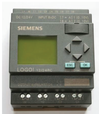
Figura 42. PLC Siemens 12-24 RC. (Fuente: Adaptado de fuente propia).
