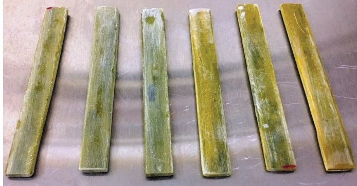
Figura 95. Probetas para el ensayo de flexión.
