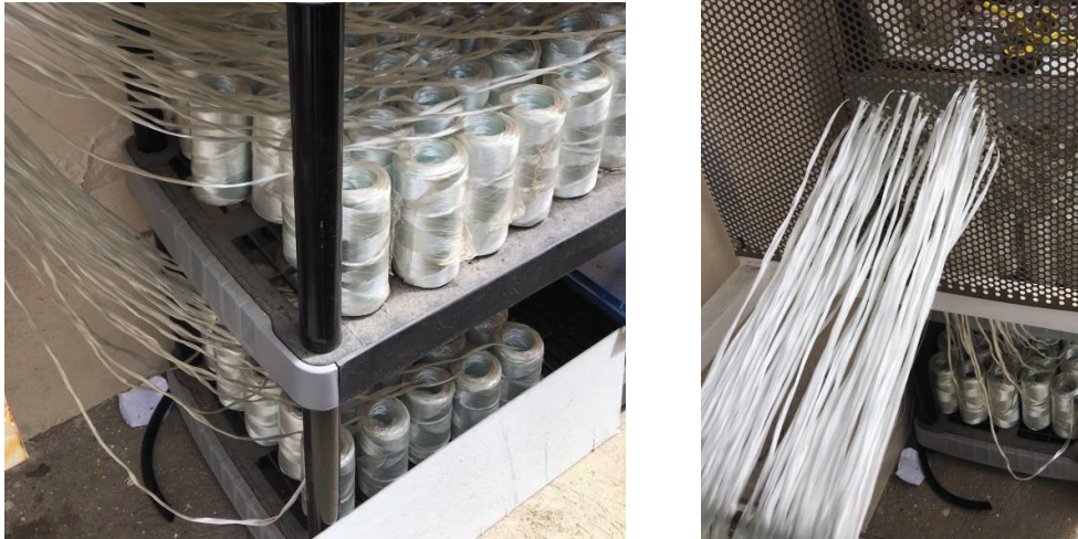
Figura 66. Desenredado de los hilos rovings. (Fuente: Adaptado de fuente propia).
