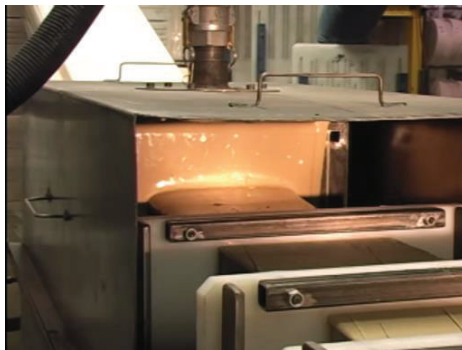
Figura 27. Sistema de Calentamiento por resina.
