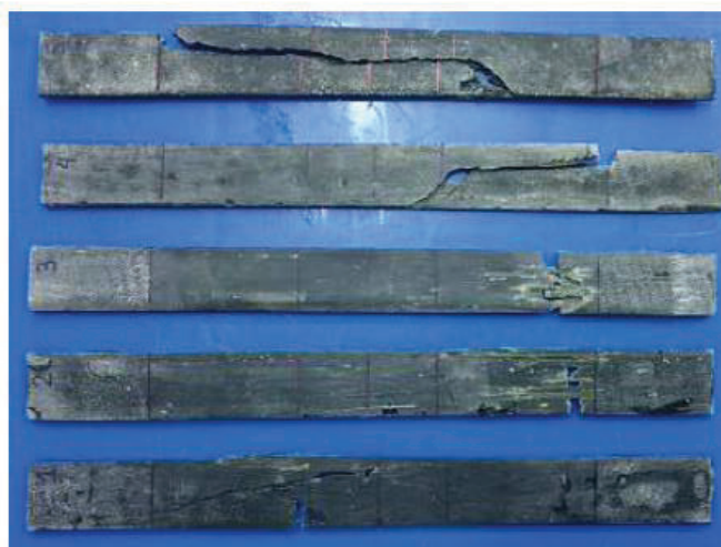
Figura 98. Probetas después de ser sometida a tracción. (Fuente: Adaptado de laboratorio de LANUM).
