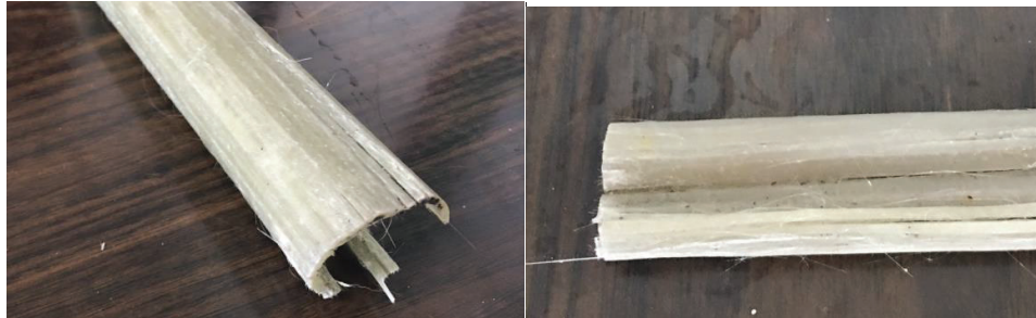
Figura 76. Perfil inestable. (Fuente: Adaptado de fuente propia).
