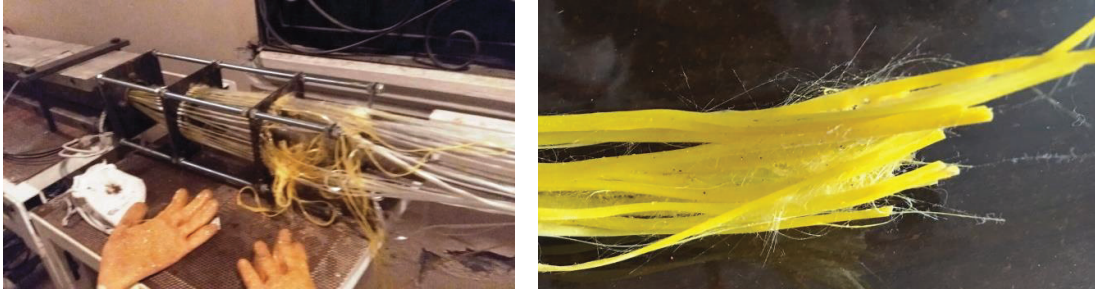
Figura 77. Rotura de hilos. (Fuente: Adaptado de fuente propia).
