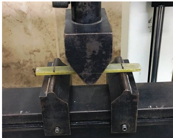
Figura 97. Probeta sometida a flexión.
