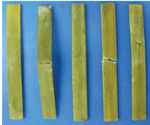
Figura 100. Probetas después de ser sometida a flexión. (Fuente: Adaptado de laboratorio de LANUM).
