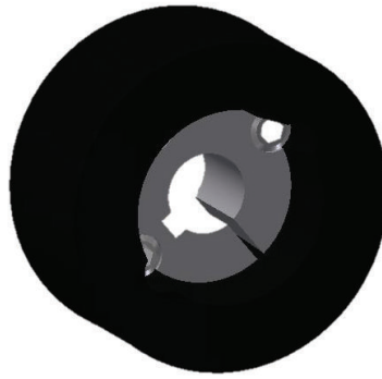
Figura 2.32. Polea con acoplamiento cónico. (Fuente: Propia)
