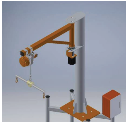
Figura 2.84. Estructura de la grúa soporte.
