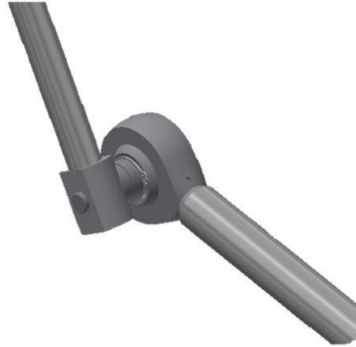
Figura 2.49. Rodamiento en la articulación biela manivela.
