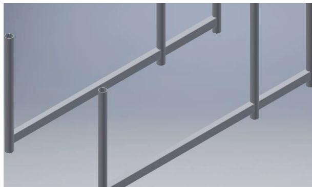
Figura 2.146. Soportes horizontales en la estructura pedestal.
