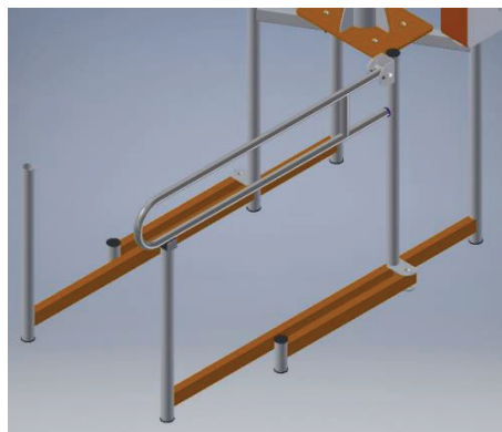
Figura 2.82. Esquema y ubicación del soporte de pasamanos. (Fuente: Propia)
