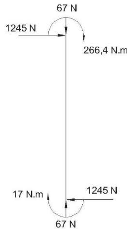
Figura 2.128. Diagrama de cuerpo libre del soporte vertical.
