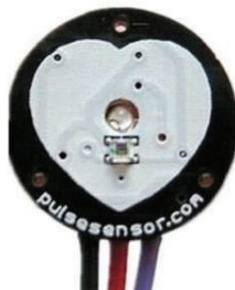
Figura 1.25 Sensor de pulso cardiaco[18]
