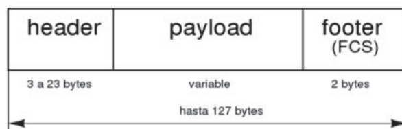
Figura 1.16 Estructura de la trama IEEE 802.15.4 [12]
