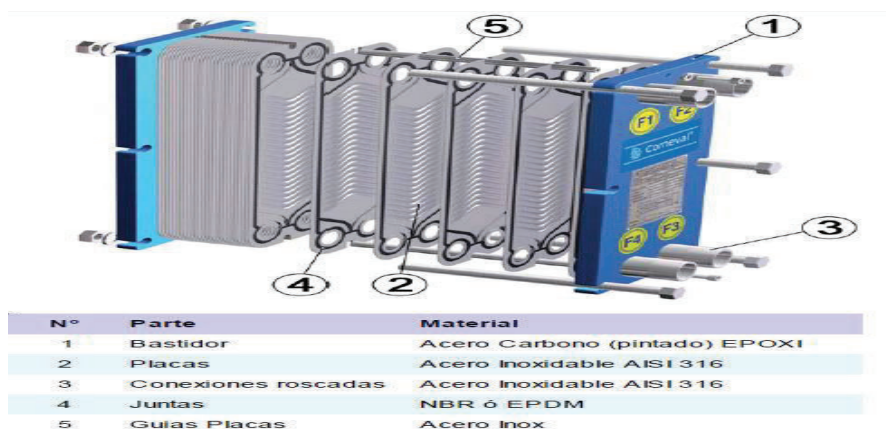
Figura 2.9. Intercambiador de calor por placas
