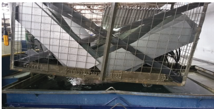
Figura 1.11. Sellado de la superficie del material por inmersión Fuente: Propia, 2016
