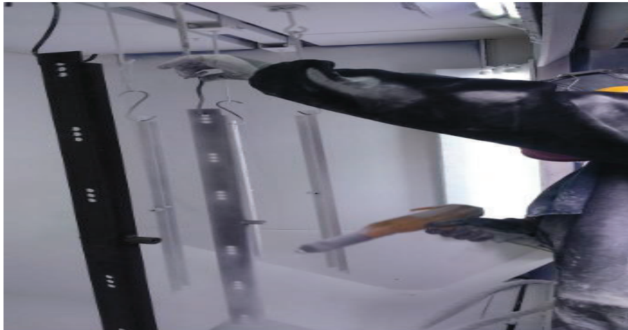
Figura 1. 14. Pintado de Piezas con Polvo Electrostático Fuente: Propia, 2016
