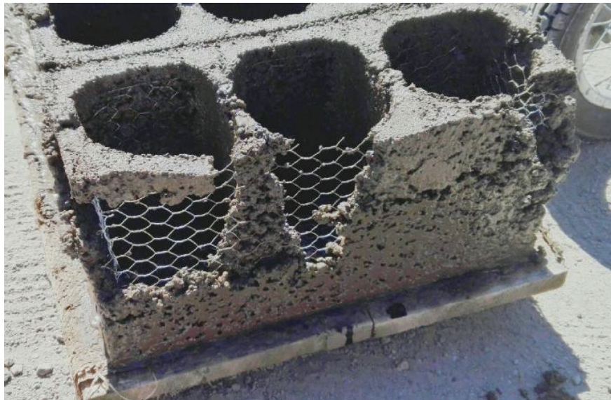
FOTO 2.8 INTENTO FALLIDO DE FUNDICIÓN DEL PROTOTIPO
