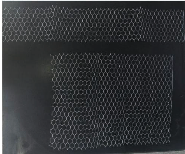
FOTO 2.5 PIEZAS NECESARIAS PARA EL ARMADO DE UN CAJÓN DE MALLA
