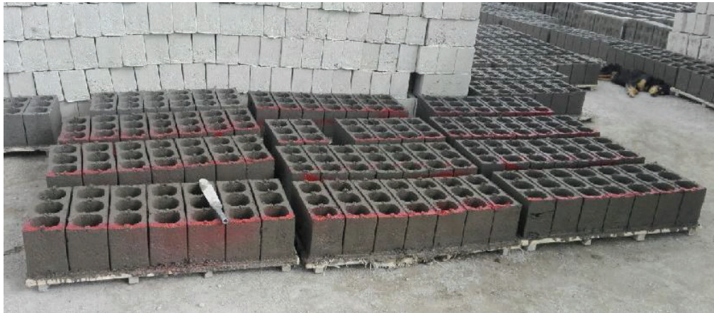
FOTO 2.13 BLOQUES PROTOTIPO DESPUÉS DE LA FUNDICIÓN
