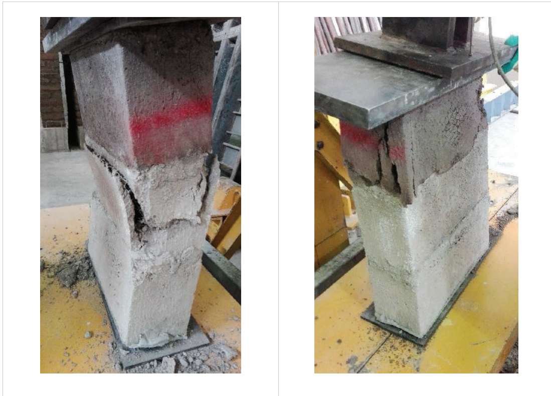
FOTO 3.4 TIPOS DE FALLAS PRESENTADOS EN LOS PRISMAS FORMADOS CON LOS PROTOTIPOS EN LOS ENSAYOS A COMPRESIÓN.
