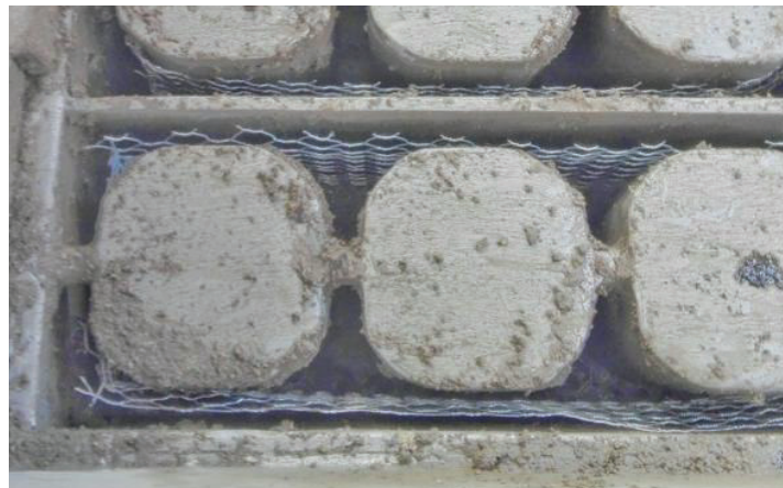
FOTO 2.12 CAJÓN DE MALLA EN EL INTERIOR DEL MOLDE LISTO PARA LA FUNDICIÓN
