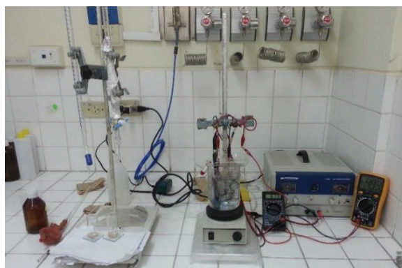
FIGURA 3.4: DISPOSICIÓN DE LOS ELEMENTOS PARA LA GENERACIÓN DE \text{H}_2\text{O}_2 EN CELDA SIMPLE
