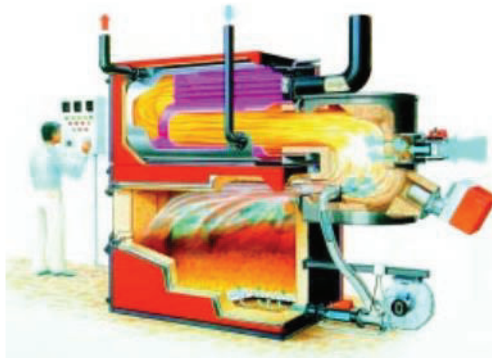
Figura 2-13: Incinerador de doble cámara.
