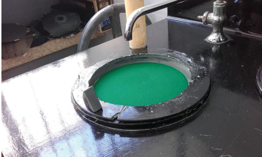
Figura 2.17. Muestra obtenida y la máquina de pulido de fondo.
