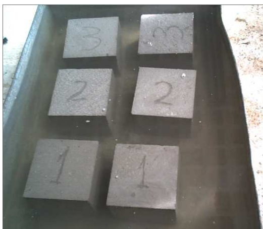
g) Desencofrado y curado
