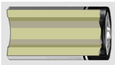
Figura N.- 2.7 Cátodo de una pila
