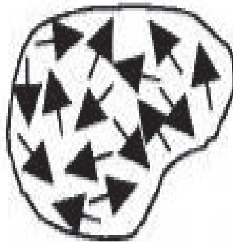
Figura 1.3. Orientación de los momentos magnéticos individuales en el paramagnetismo (Hafeli y Chastellain, 2006, p. 400)
