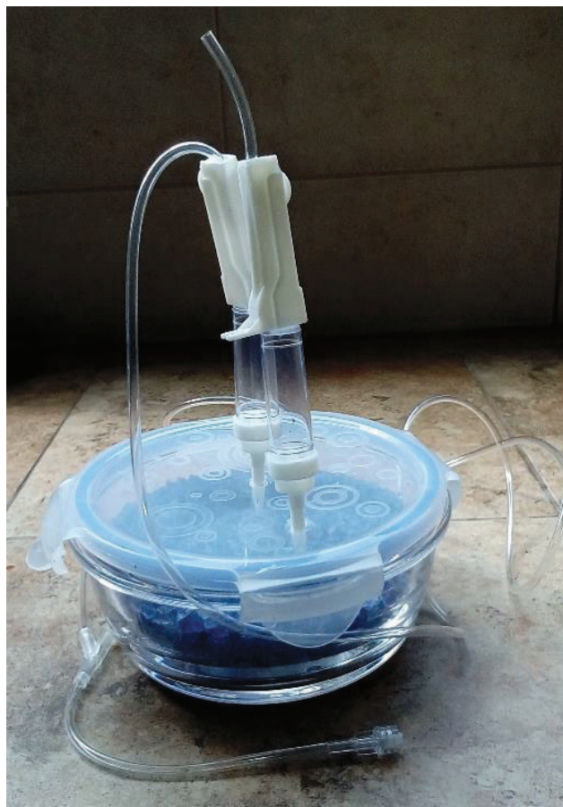
Figura 2.2. Configuración de la cámara con atmósfera inerte usada para aislar las partículas de hierro sintetizadas
