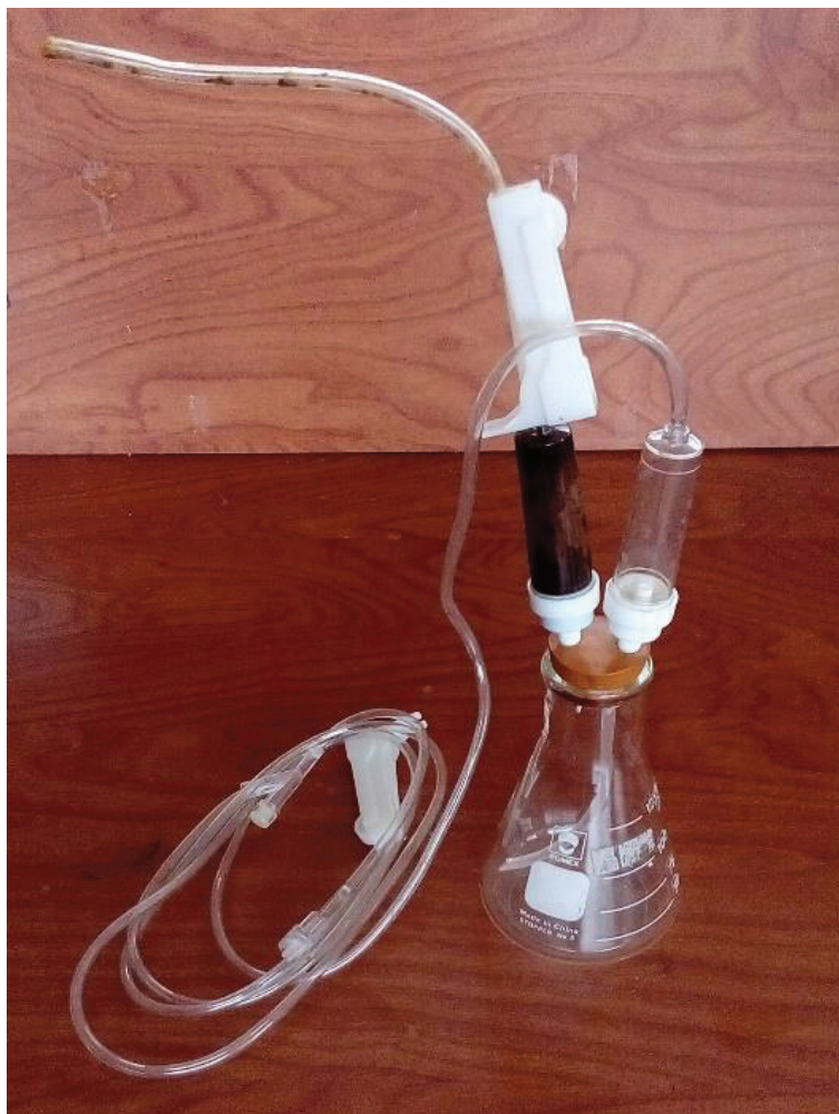
Figura 2.1. Configuración del reactor acoplado con mangueras de PVC para mantener atmósfera inerte
