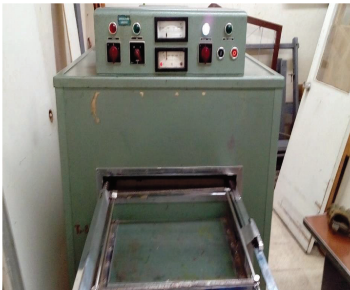
Figura 2.5. Equipo usado para los procesos de secado y termo fijado de las muestras de tejido de poliéster
