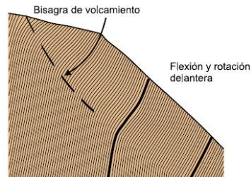
Figura 2.7 Esquema de Vuelco del macizo rocoso. Fuente: (Proyecto Multinacional Andino: Geociencias para las Comunidades Andinas, 2007)
