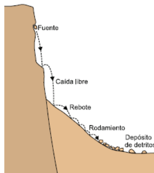
Figura 2.6 Esquema de Caída. Fuente: (Proyecto Multinacional Andino: Geociencias para las Comunidades Andinas, 2007)
