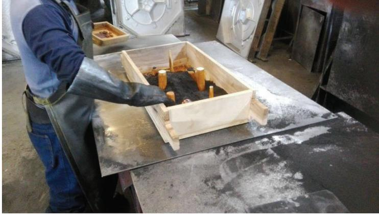
Figura 5.2. Llenado de arena en la caja de moldeo del cigüeñal
