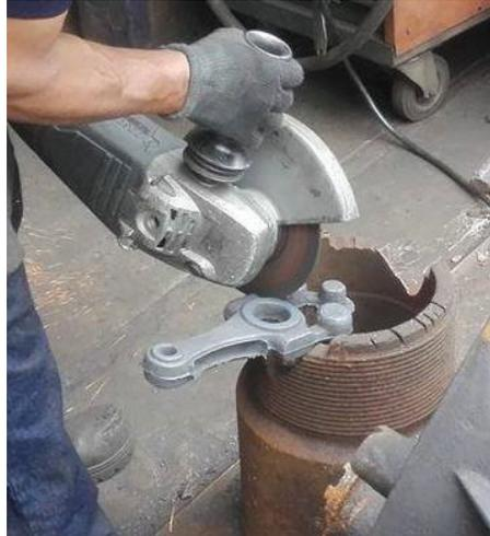
Figura 5.16. Corte de los sistemas de alimentación de la biela
