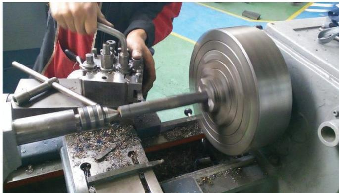
Figura 5.29. Cilindrado del bloque
