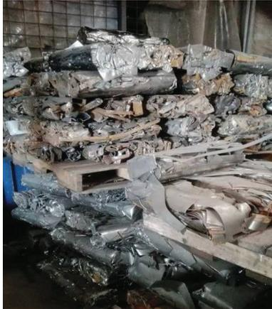
Figura 2.1. Chatarra de aceros estructurales y transformables eléctricos
