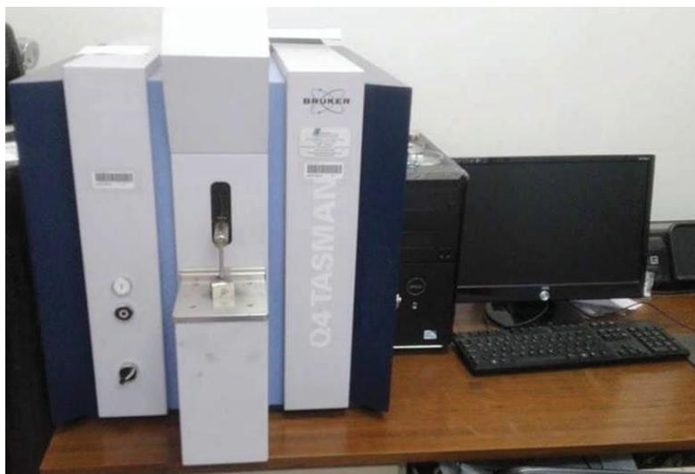
Figura 5.58. Espectrómetro de chispa
