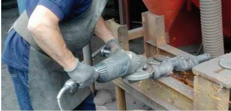
Figura 5.22. Esmerilado de la superficie del cigüeñal
