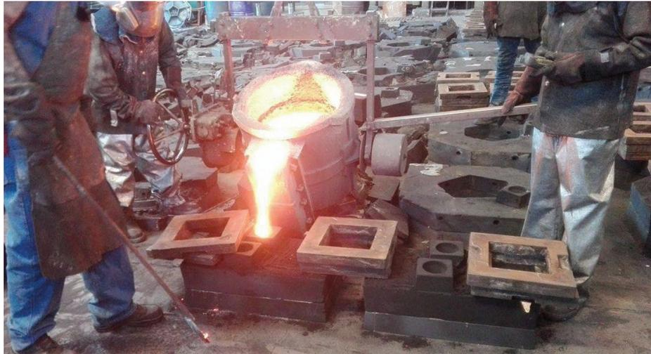
Figura 5.11. Colado en el molde de arena del cigüeñal
