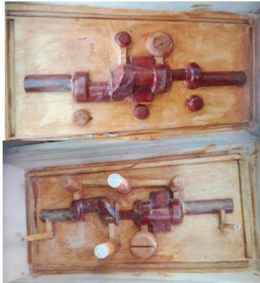
Figura 4.66. Placa modelo cigüeñal macho y hembra
