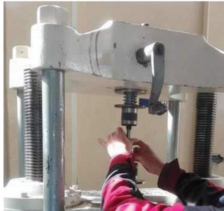
Figura 5.35. Enroscado de la probeta
