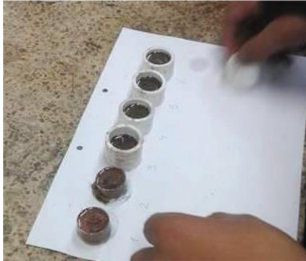
Figura 5.46. Desmoldeo de las probetas
