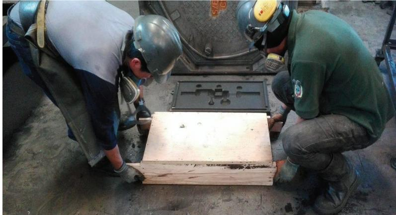
Figura 5.5. Desmoldeo de las cajas
