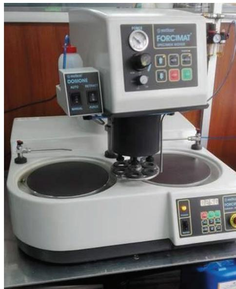
Figura 5.47. Máquina automática de lijado y pulido
