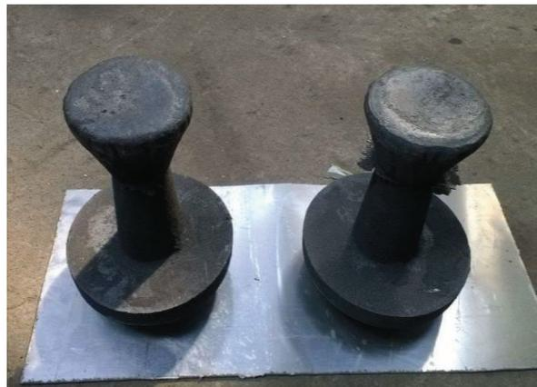
Figura 5.15. Tapas de rodamientos en bruto obtenidas
