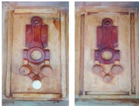
Figura 4.67. Placa modelo biela macho y hembra
