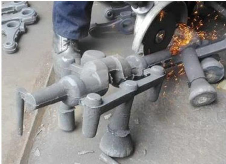
Figura 5.21. Corte de los sistemas de alimentación del cigüeñal
