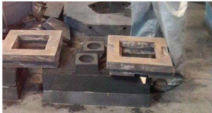
Figura 5.8. Molde de arena armado y con pesas
