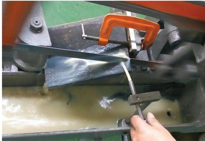
Figura 5.28. Corte de los bloques
