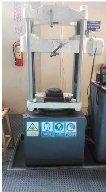
Figura 5.33. Maquina I de ensayos a tracción
