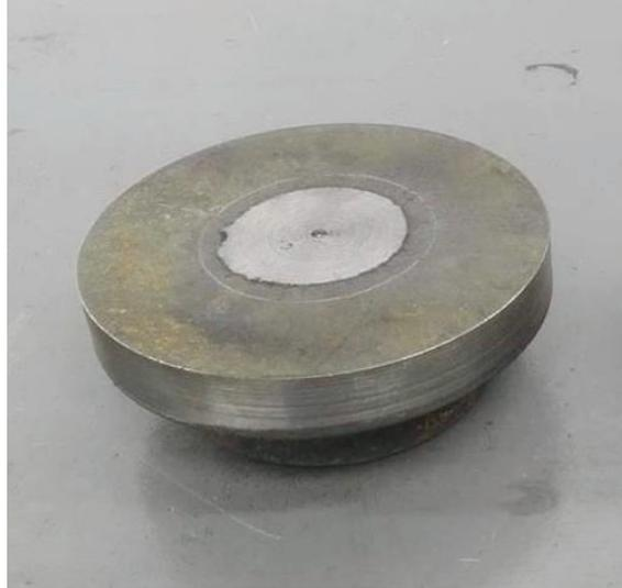
Figura 5.20. Tapa de rodamiento torneada
