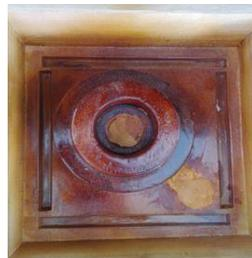
Figura 4.68. Placa modelo tapas macho y hembra
