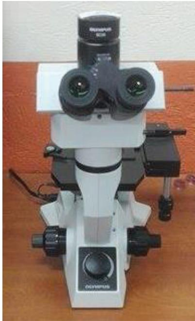
Figura 5.54. Microscopio metalográfico
