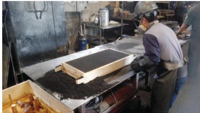
Figura 5.3. Compactación de la arena en maquina compactadora
