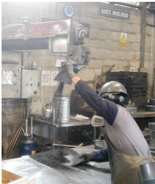
Figura 5.1. Mezclado de la arena de moldeo (Arena sílica, resina furánica 1%, y catalizador 0.5%) en máquina mezcladora
