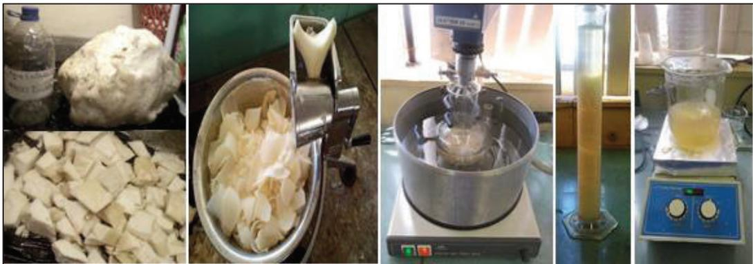
**Figura 2.3.** Línea de secuencia para la extracción y purificación de inulina. Reducción de tamaño, extracción, deproteinización y concentración
