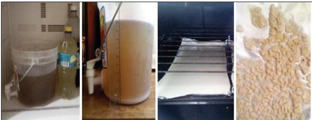
**Figura 2.4.** Línea de secuencia para la obtención de cristales de inulina. Subenfriamiento, decantación y secado
