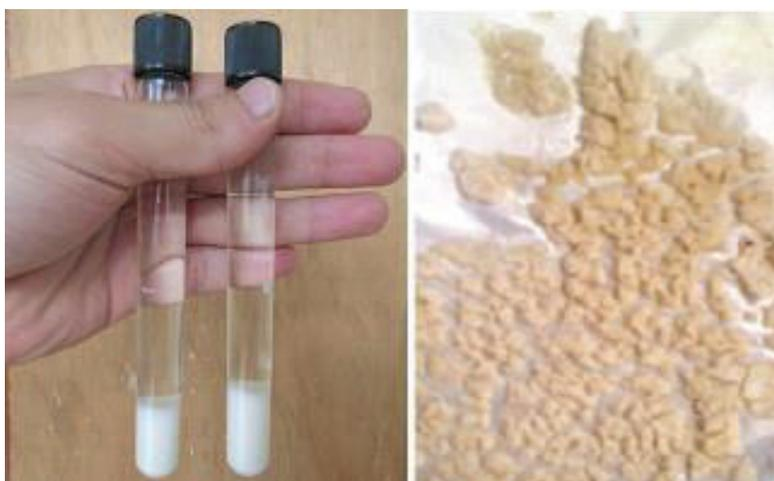
**Figura 3.15.** Cristales de inulina obtenidos por precipitación en mezclas de etanol-agua al 30 % w/w y refrigeración
