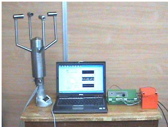
Figura 4.1 Prueba de estabilidad y offset
