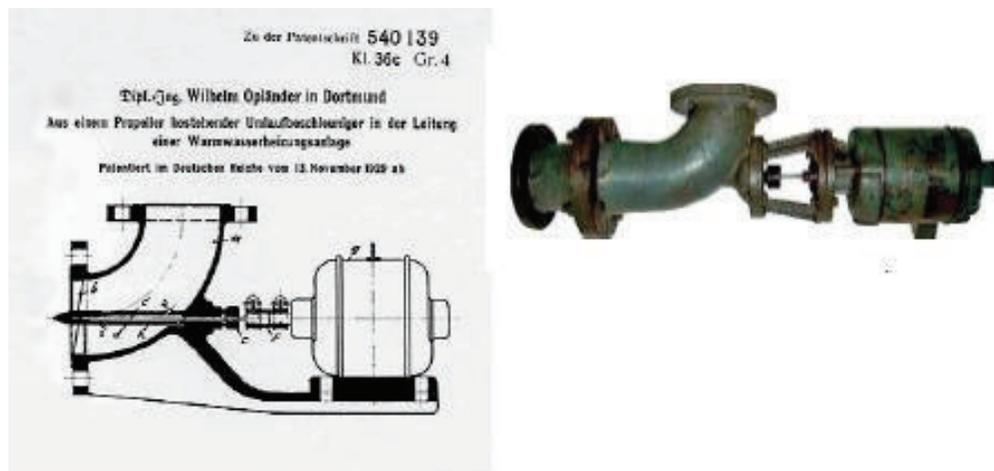
**Figura 1.2** Diseño y Construcción de la primera bomba de recirculación(WILO, 2010)
