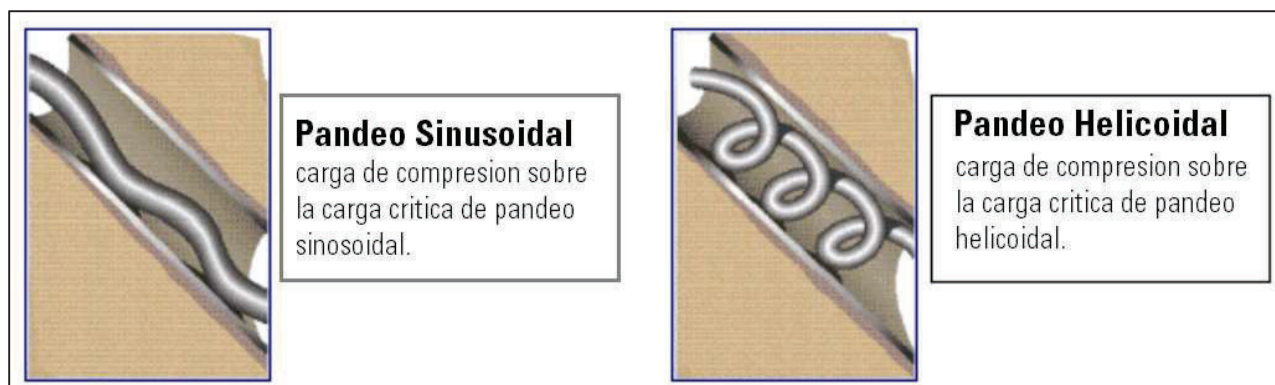
Figura 2.37: Pandeo de la sarta de perforación sinusoidal y helicoidal Tomado del Departamento DS/WFT – Ecuador
