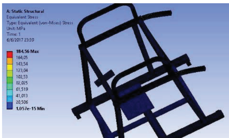
Figura 118. Base, equivalente de Von Mises.
