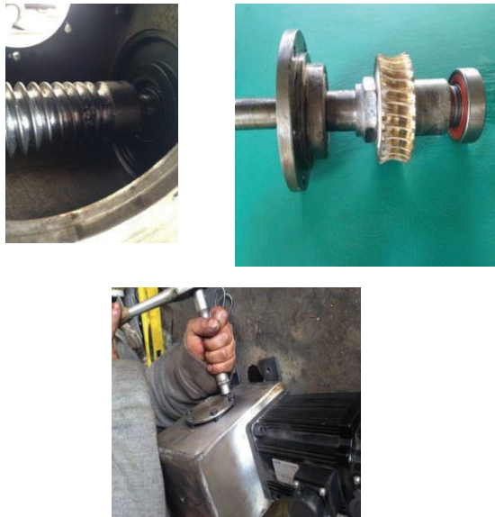
Figura 194. Pruebas mecánicas en el reductor de velocidad. (Fuente: Autores).
