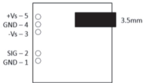
Figura 11. Diagrama de conexión del dispositivo muscle sensor V3.
