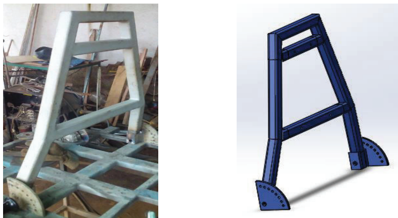
Figura 130. Estructura del espaldar del banco de rehabilitación.
