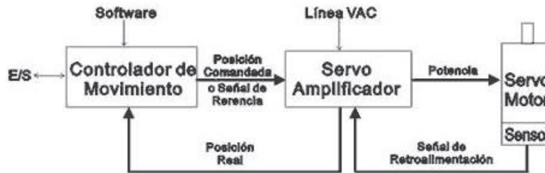
Figura 15. Parámetros básicos de control del servomotor AC GSK.
