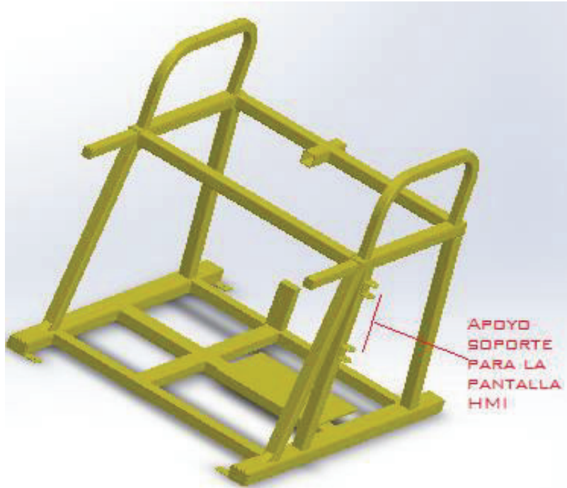
Figura 113. Apoyo del soporte para la pantalla HMI.
