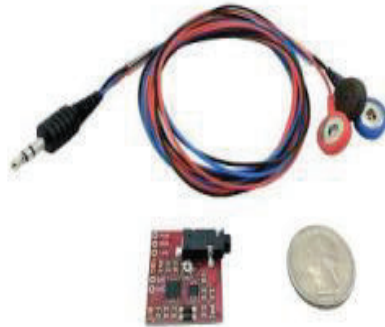
Figura 173. Tarjeta de sensor mioeléctrico para registro de señales electromiográficas.
