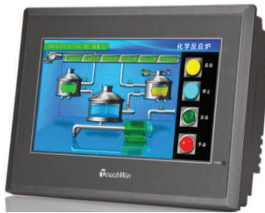
Figura 145. Panel de operador.
