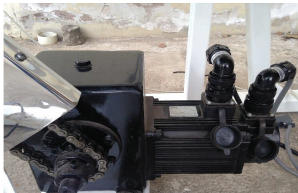
Figura 195. Transmisión de movimiento con cadena. (Fuente: Autores).
