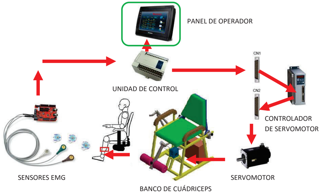
Figura 144. Diagrama global de funcionamiento de la máquina de rehabilitación.
