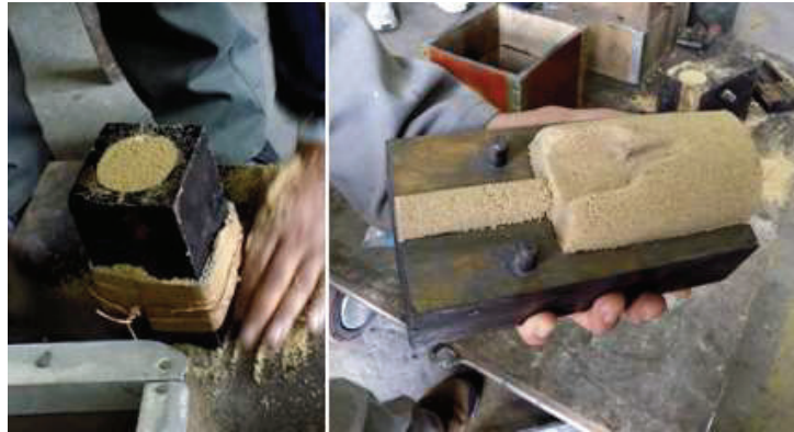
Figura 2.22. Noyo del pistón. (Fuente: Propia)
