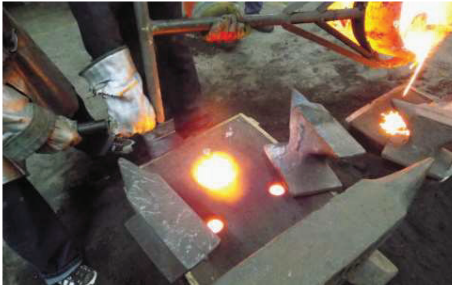
Figura 2.29. Vertido del metal líquido. (Fuente: Propia)
