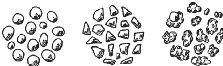
Figura 1.17. Formas de granos de la arena base: grano esferoidal, angulado y compuesto.
