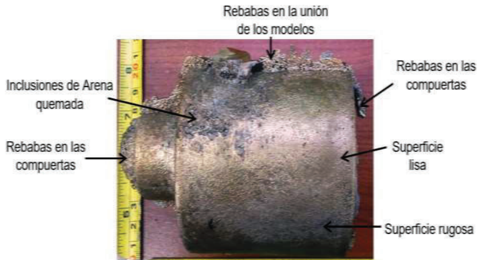
Figura 3.18. Discontinuidades superficiales del pistón. (Fuente: Propia)
