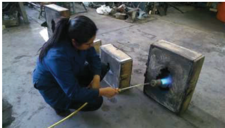
Figura 2.26. Flameado de los moldes. (Fuente: Propia)
