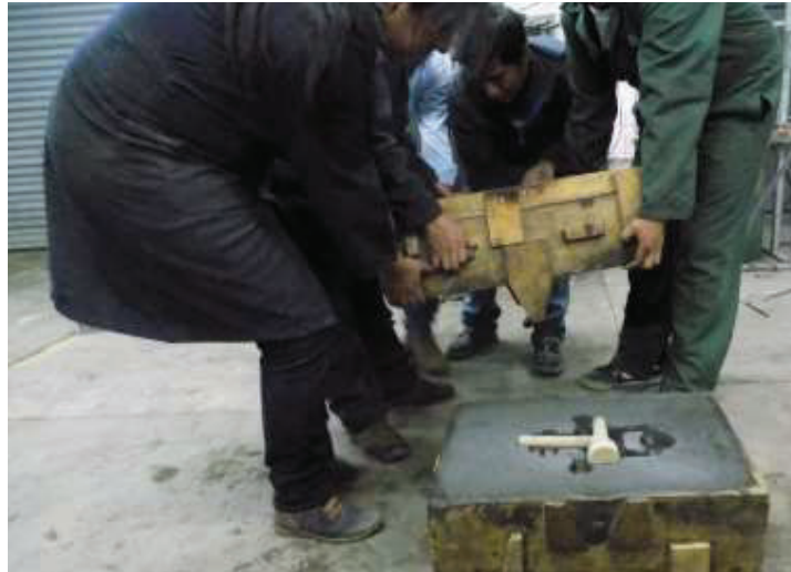
Figura 2.27. Sellado de las cajas. (Fuente: Propia)
