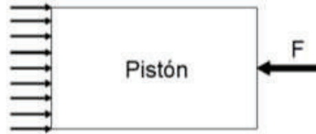
Figura 1.8. Diagrama de cuerpo libre del pistón. (Fuente: Propia)
