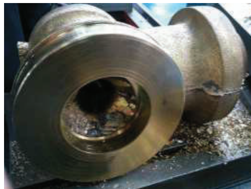
Figura 3.10. Cámara de presión luego del cilindrado y refrentado de las bridas. (Fuente: Propia)
