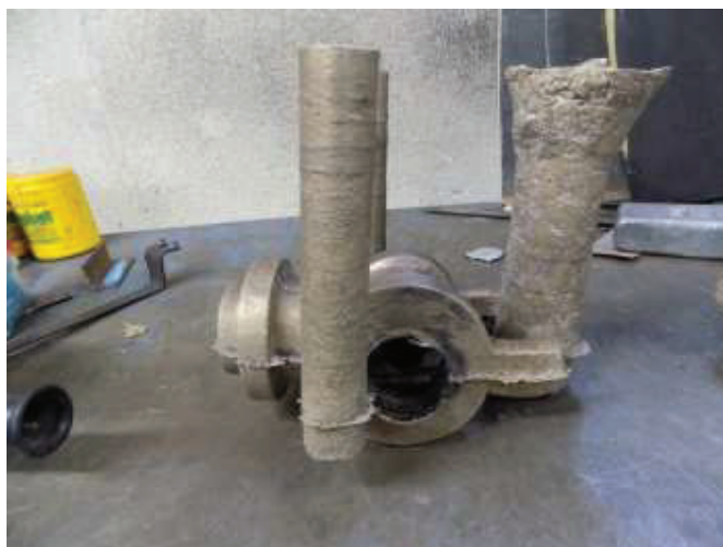
Figura 3.6. Vista lateral de la cámara de presión. (Fuente: Propia)
