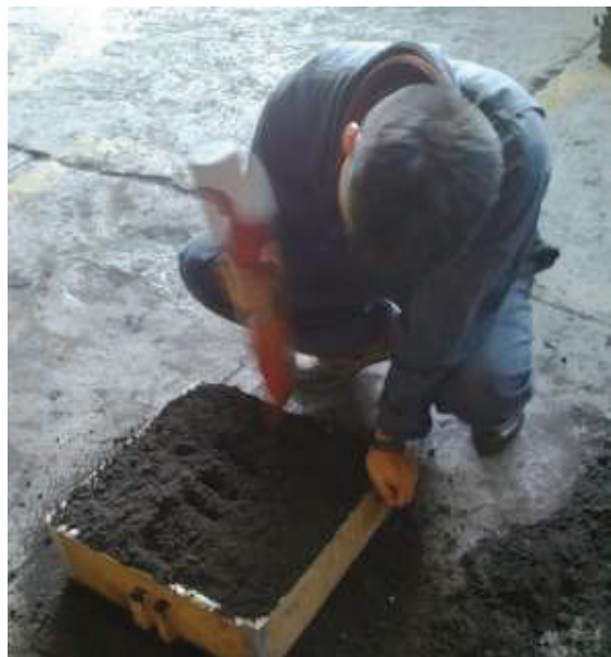
Figura 2.24. Moldeo en cajas de madera. (Fuente: Propia)
