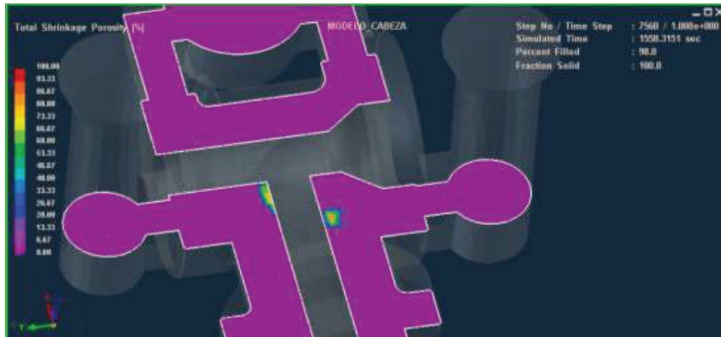
Figura 2.20. Porosidades en la cámara de presión. (Fuente: Propia)
