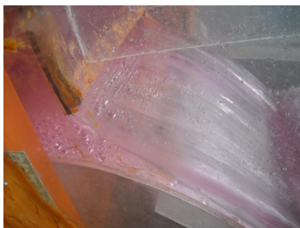
FIGURA 6.1 COMPORTAMIENTO HIDRÁULICO DEL PERFIL DEL VERTEDERO CON LA COMPUERTA RADIAL PARCIALMENTE ABIERTA A 1.80 METROS EN EL MODELO FÍSICO
