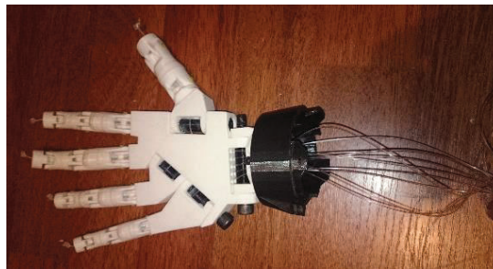
Figura 3.80. Ensamble y transmisión de los dedos de la mano. (Fuente: Propia)
