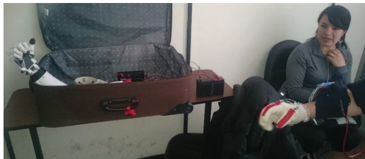
Figura 3.86. Pruebas de funcionamiento del guante sensorial con la mano inalámbrica (Fuente: Propia)
