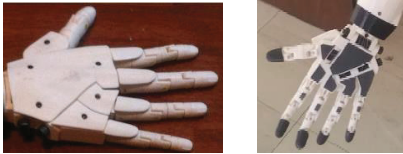
Figura 3.82. Mano impresa terminada y ensamblada.
