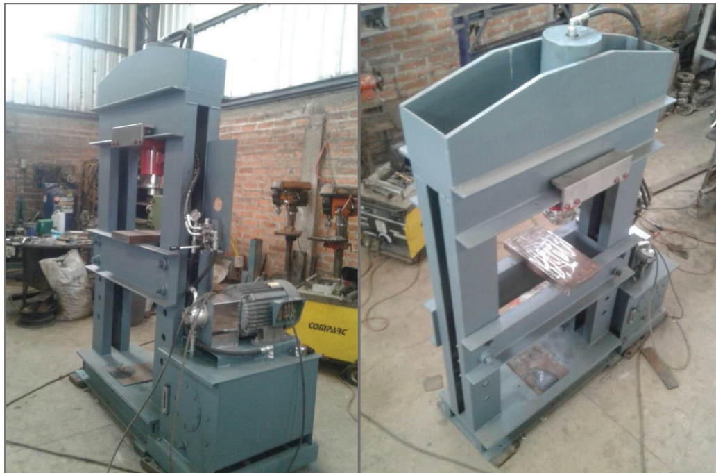
Figura 5.7. Prensa hidráulica para corrección de bordes de láminas metálicas..
