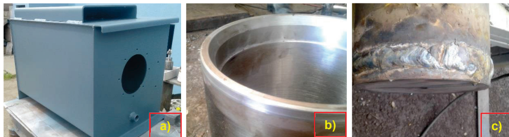
Figura 5.4. Construcción del módulo cilindro hidráulico: a) tanque hidráulico, b) cilindro hidráulico y c) cordón de soldadura en la base del cilindro.
