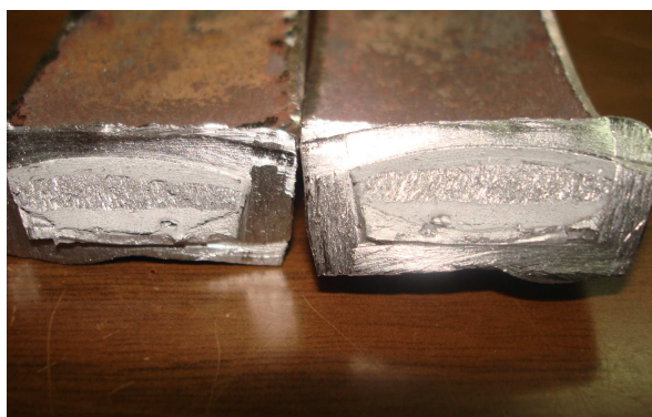
Figura 3.18 Ensayo de Rotura con Muesca (NB)
