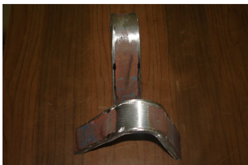
Figura 3.14 Ensayo de doblado de cara
