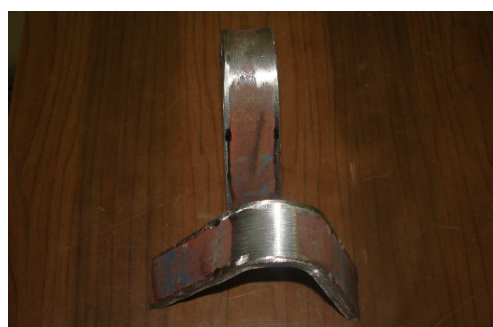
Figura3.16 Ensayo de Doblado de Raíz
