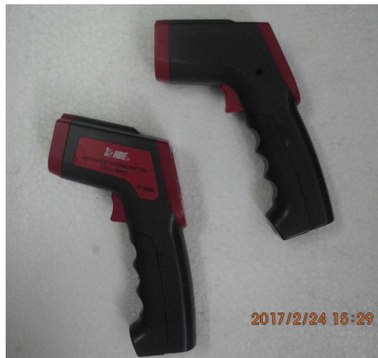
Figura 3.2. Termómetros infrarrojos ST-380 a , (Fuente: Autor)
