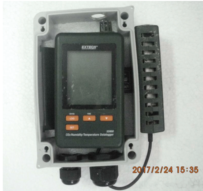
Figura 3.4. Registrador de CO 2 humedad y temperatura EXTECH SD-800, (Fuente: Autor)
