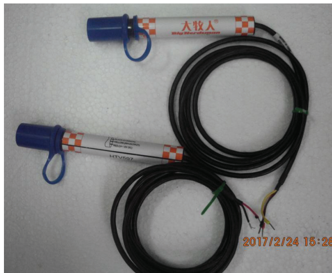
Figura 3.6. Sensores de humedad Big Herdsman HTV597, (Fuente: Autor)
