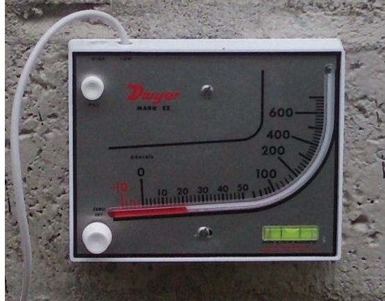
Figura 2.13. Caída de presión en el panel húmedo, (Fuente: Autor)
