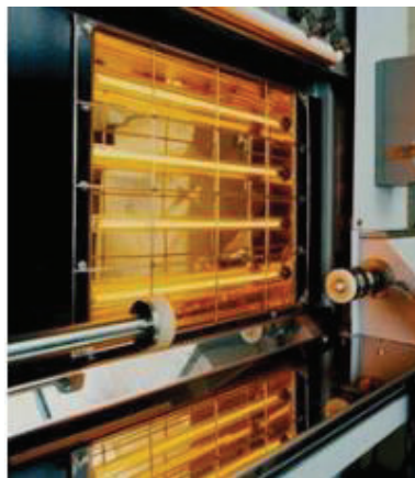
Figura 2.7. Vista de calentador eléctrico de tubos de cuarzo, (Fuente: Understanding Infrared Heating, Heraeus Noblelight [45])
