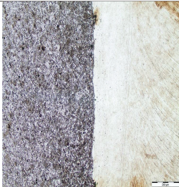
Figura Y. Zona de la junta en la que se observa varios lugares de la interfase de soldadura en los que no se tiene buena unión ni mezcla de materiales. Aumento de 100X con ataque químico
