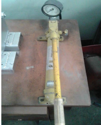
Figura 2. 3. Bomba Hidráulica de la máquina. (Fuente Propia, 2017)
