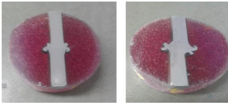
Figura 2. 10. Corte y montaje de juntas soldadas. (Fuente Propia, 2017)
