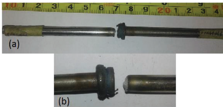
Figura 3. 23. (a)Probeta 9EF luego del ensayo de tracción (b)Fallo metal base. (Fuente Propia, 2017)
