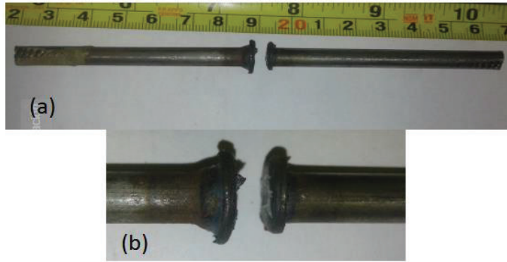
Figura 3. 15. (a) Probeta 1EF luego del ensayo de tracción (b) Fallo junta soldada. (Fuente Propia, 2017)
