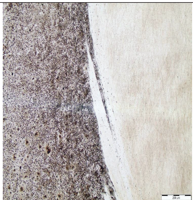
Figura AE. Zona de la junta en la que se observa buena unión en la interfase de la soldadura además de mezcla de materiales, las inclusiones presentes en el acero al carbono son notorias. Aumento de 100X con ataque químico.
