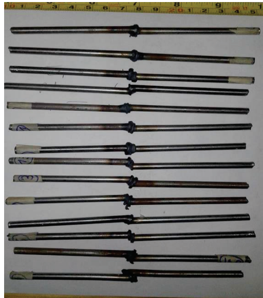
Figura 3. 3. Probetas soldadas en la primera prueba para relacionar parámetros. (Fuente Propia, 2017)
