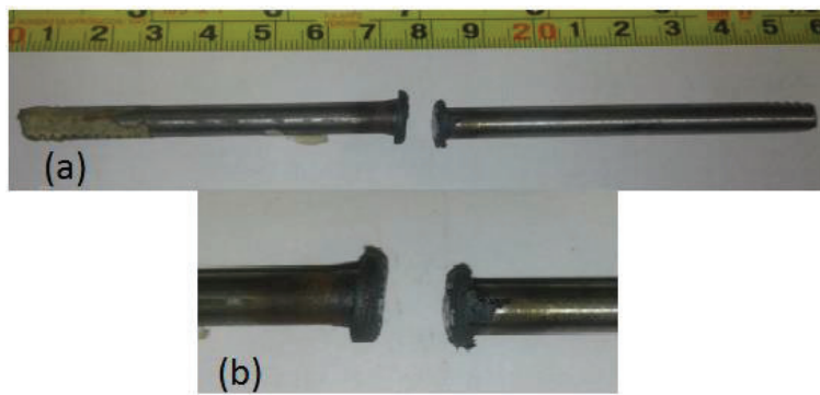
Figura 3. 16. (a) Probeta 2EF luego del ensayo de tracción (b) Fallo junta soldada. (Fuente Propia, 2017)
