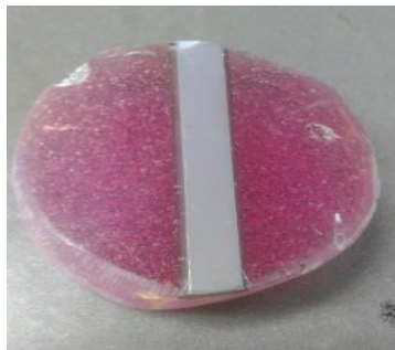
Figura 2. 11. Corte y montaje de material base. (Fuente Propia, 2017)
