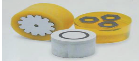
Figura 1. 17. Inclusiones metalográficas en frío. (Exámen Metalográfico, 2010)
