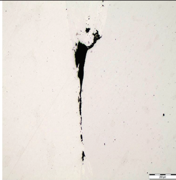
Figura W. Zona de la junta en la que se observa una gran discontinuidad en la interfase de la soldadura, no se distingue una mezcla de materiales. Aumento 100X sin ataque químico.
