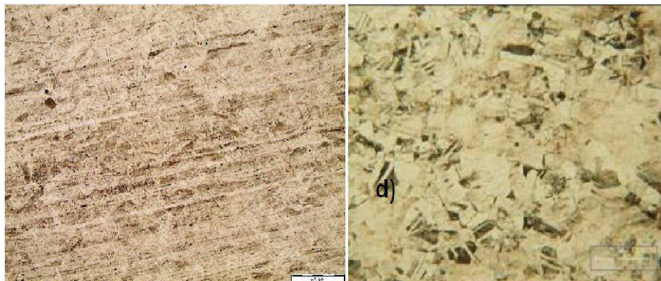
Figura 3. 26. (a) Metalografía material base (b) Metalografía de Pérez y otros. (Pérez, y otros, 2014)
