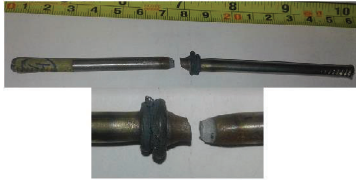
Figura 3. 18. (a) Probeta 4EF luego del ensayo de tracción (b) Fallo metal base. (Fuente Propia, 2017)
