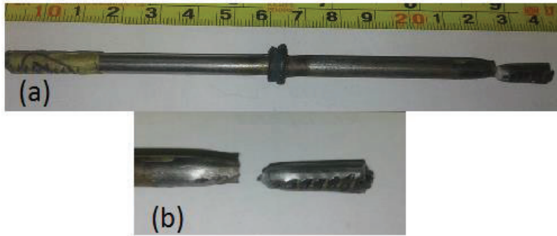
Figura 3. 21. (a)Probeta 7EF luego del ensayo de tracción (b)Fallo metal base. (Fuente Propia, 2017)
