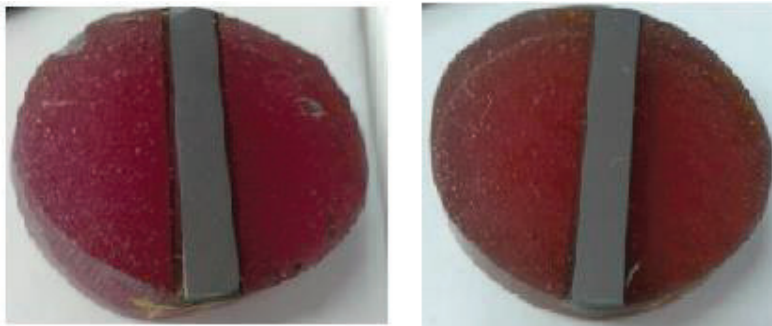
Figura 2. 7. Obtención de la muestra para el análisis químico.
