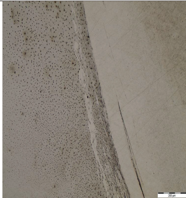
Figura AU. Zona de la junta en la que se observa la interfase de soldadura perfectamente unida, se nota la mezcla mecánica de los materiales y muchas inclusiones. Aumento de 100X con ataque químico.
