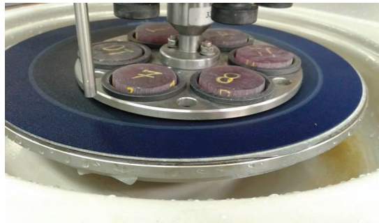
Figura 2. 13. Pulido de las probetas. (Fuente Propia, 2017)
