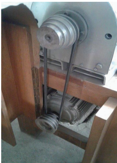
Figura 2. 2. Sistema de poleas de la máquina. (Fuente Propia, 2017)
