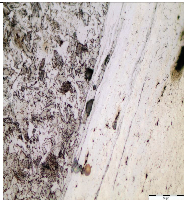
Figura AF. Zona de la junta en la que se observa una interfase de soldadura buena sin defectos, mezcla de materiales y la distorsión de los granos. Aumento de 500X con ataque químico.
