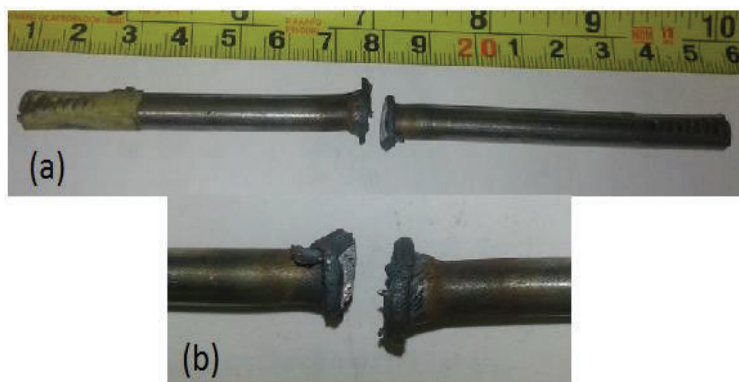
Figura 3. 17. (a) Probeta 3EF luego del ensayo de tracción (b) Fallo junta soldada. (Fuente Propia, 2017)
