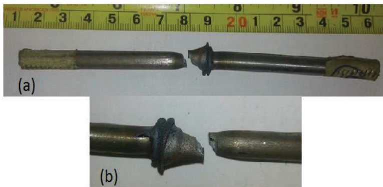
Figura 3. 20. (a) Probeta 6EF luego del ensayo de tracción (b) Fallo metal base. (Fuente Propia, 2017)
