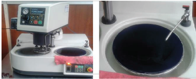
Figura 2. 12. Pulidora Forzipol con paño de 1 micrón. (Fuente Propia, 2017)
