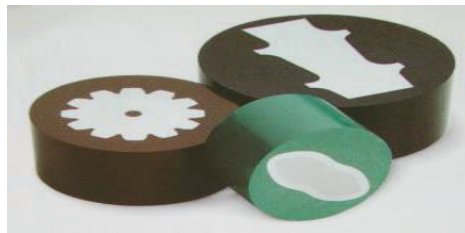
Figura 1. 16. Inclusiones metalográficas en caliente.
