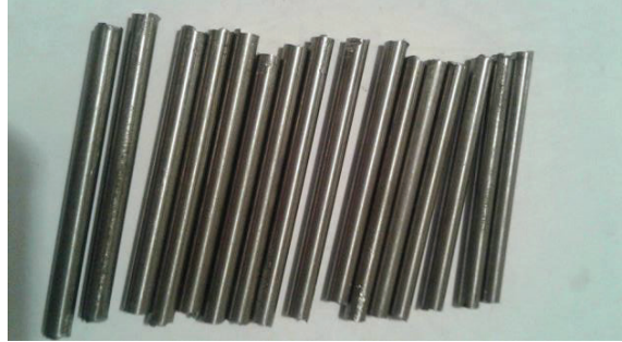
Figura 2. 4. Probetas de Acero al carbono AISI 1018.
