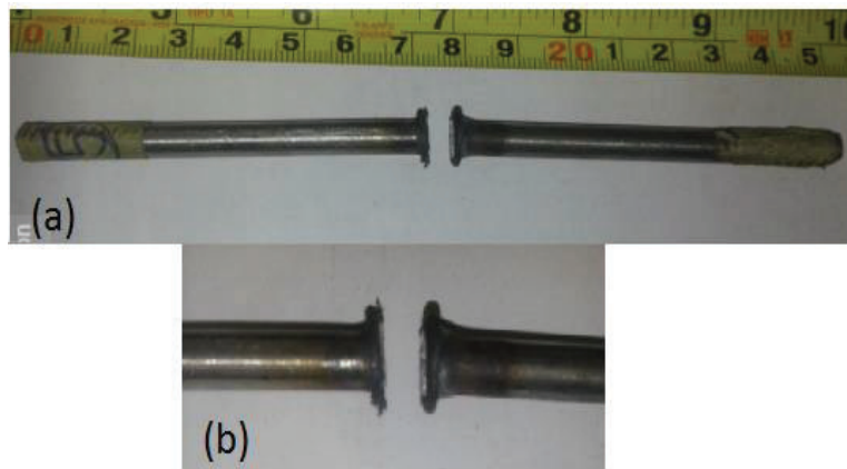
Figura 3. 19. (a) Probeta 5EF luego del ensayo de tracción (b) Fallo junta soldada. (Fuente Propia, 2017)
