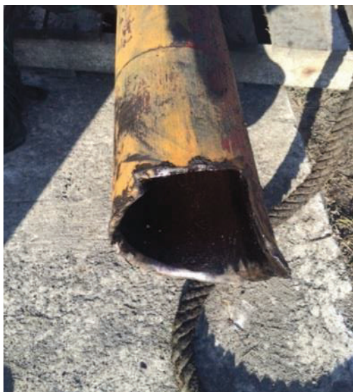
Figura 3.7. BHA de pesca con presencia de daño
