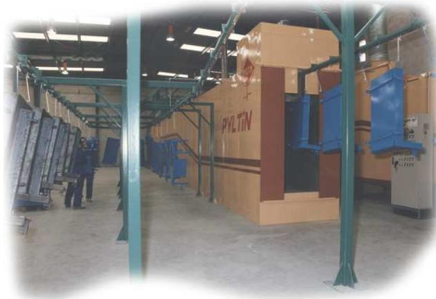
*Fig. 3.8 Cabinas de aplicación*
