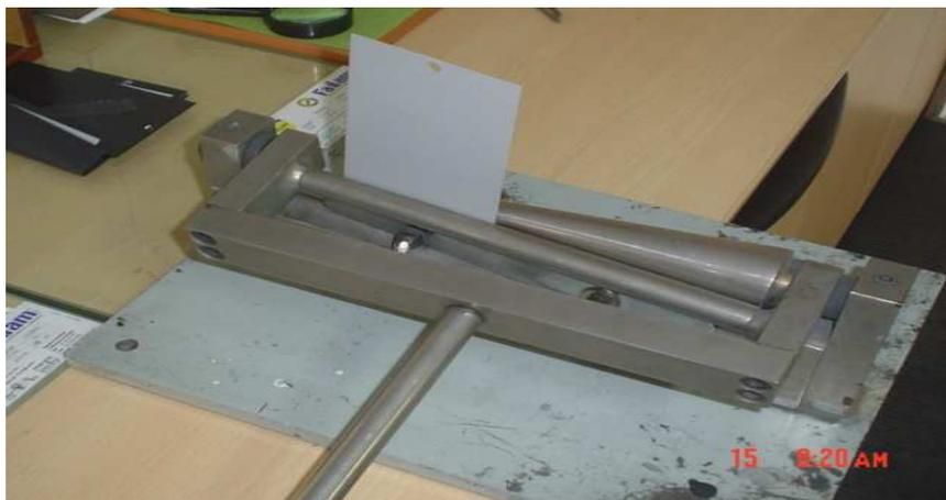
*Fig. 4.3 Implementos para el ensayo de flexibilidad*
