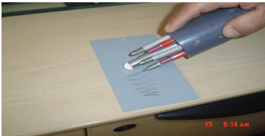
*Fig. 4.2 Ejecución del ensayo de dureza*
