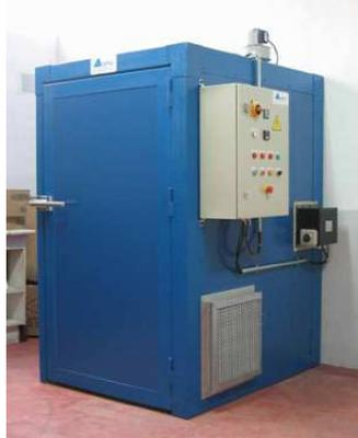
*Fig. 3.14 Horno por radiación*
