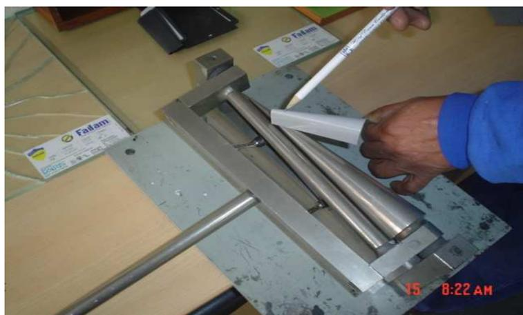
*Fig. 4.4 Ejecución del ensayo de flexibilidad*
