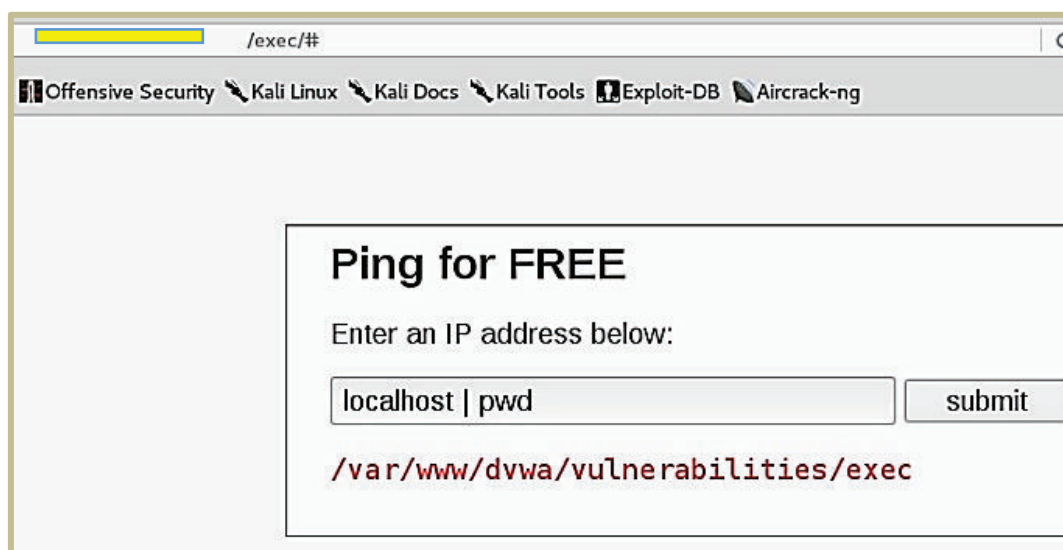
Figura 3.35 Inyección de comando
